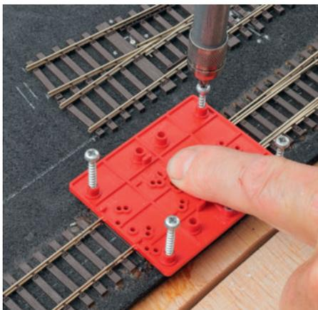
Die Schablone wird positioniert.
