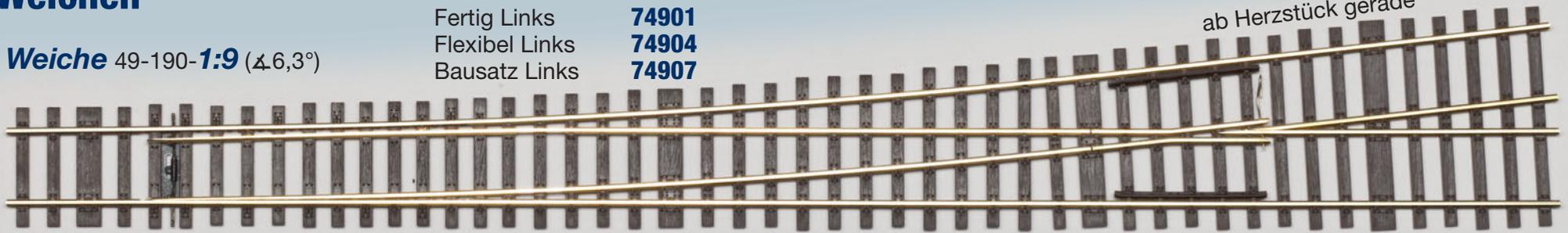
Länge der 1:9-Weichen: 375 mm; Radius im abzweigenden Gleis: 2180 mm
