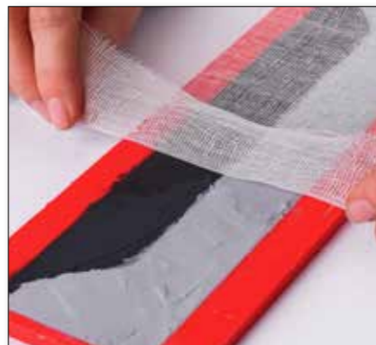
Hinzufügen einer Textilschicht, um ein Auseinanderreißen zu vermeiden. Adding a reinforcement (textile) layer to the product to avoid tearing apart.
