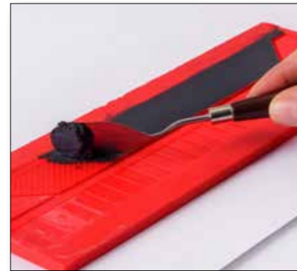
Die Silikonform wird mit der ersten Lage der Rohmasse verfüllt. Filling the silicone mould with the first layer of the material.
