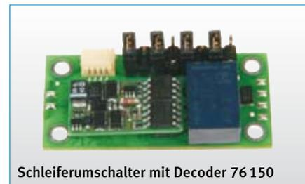
Der Decoder 76150 wird einfach auf den Schleiferumschalter aufgesteckt.
