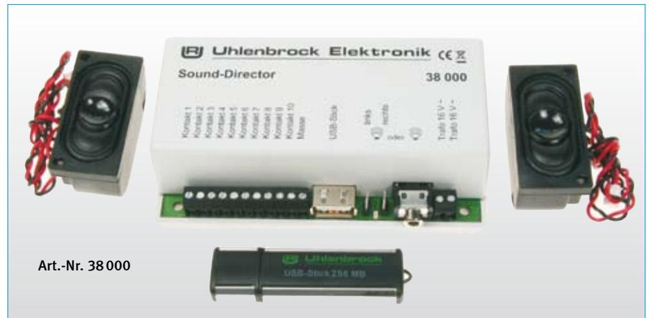
Bei Anschluss ans LocoNet können die Geräusche auch durch einen fahrenden Zug über Rückmelder, Weichenbefehle oder das LISSY-System ausgelöst werden. Im LISSY-System kann ein Zug sogar seine eigene, nur für ihn gültige, Bahnhofsdurchsage abrufen.
