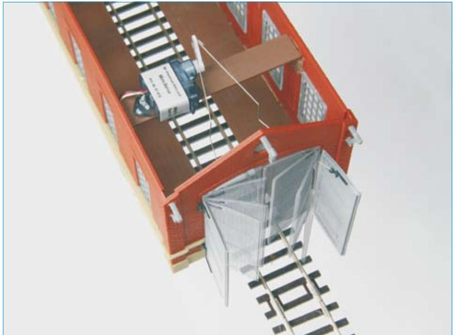
Anwendungsbeispiel: Der Mini-Servo öffnet die Tore eines Lokschuppens.
