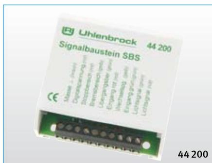
Der Signalbaustein ist eine Kombination aus einem Umschaltrelais und einem digitalen Anfahrt-Bremsbaustein. Er ermöglicht die Einrichtung einer Bremsstrecke und den Anschluss eines Lichtsignals mit Zugbeeinflussung. Lokomotiven mit Digitaldecodern halten dann vor einem roten Signal langsam an. Das Bremsverhalten der Lok wird durch die eingestellte Bremsverzögerung am Decoder vorgegeben.
