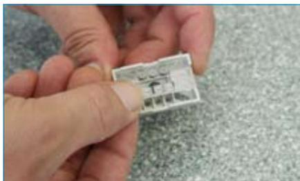
4. Stecken Sie die Segmente zusammen und fixieren Sie sie mit den beiliegenden Steckverbindern. Verbindungsplatinen mit und ohne Ausleuchtung verbinden hierbei Weichen- oder Signalplatinen innerhalb einer Segmentreihe. Kreuzverbinder verbinden die einzelnen Segmentreihen untereinander.
