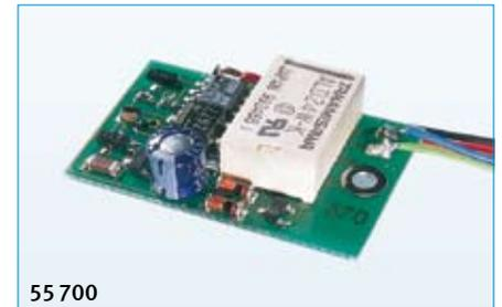
Der FRU-M ersetzt den mechanischen Umschalter in Wechselstromlokomotiven. Seine Größe entspricht der des mechanischen Umschalters, so dass zum Einbau keine mechanischen Veränderungen am Fahrzeug vorgenommen werden brauchen.
