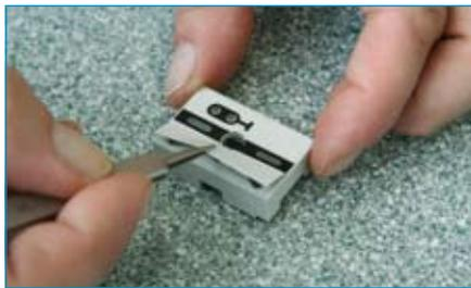
3. Drehen Sie die Segmente um. Legen Sie die Streuscheiben, falls benötigt die Tastenkappen, und die Platinen in die Segmente.
