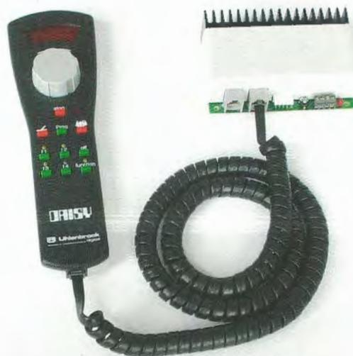
DAISY ist ein sowohl analog als auch digital einsetzbares Steuerungssystem für N-, TT- und HO-Modellbahnanlagen. Es besteht aus dem Handregler DAISY und dem Booster Power 2.
