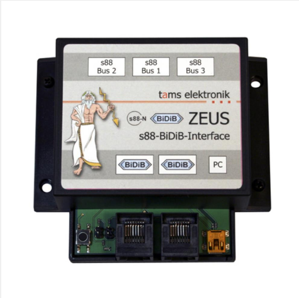
[ZEUS](#) kann als reines PC-Interface für den s88-Bus eingesetzt werden. Er überträgt die Rückmeldungen von bis zu 96 s88-Rückmeldern an den PC.
