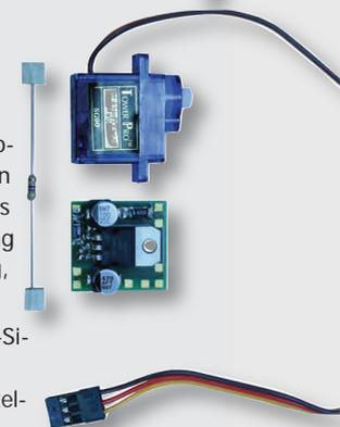
Hinweis zu den Servo-Ausgängen der LC-NG-Module: Das Servosignal der LC-NG-Module ist ein 50-Hz-Signal (20 ms Periodenlänge), welches langsam zwischen 1 Millisekunde (linker Anschlag = 0 Grad) und 2 Millisekunden (rechter Anschlag, 90 Grad) wechselt.
