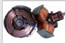
Links ein Scheibenkollektor, rechts ein Trommelkollektor. Am Rand des Scheibenkollektors sind deutliche Abnutzungsspuren erkennbar, im Betrieb ist der Kontakt zu den Bürsten reine Glücksache. Dass dieser Kollektor schon diverse Betriebsstunden mit intensivem Bürstenfeuer hinter sich hat, ist am Lochfraß auf der Kollektorscheibe gut zu erkennen.
