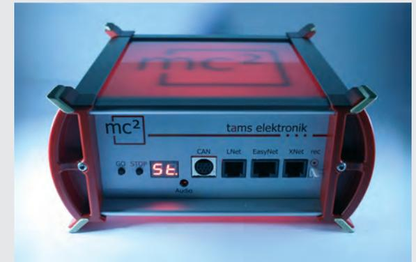
rot = Stopp. Die Gleisspannung ist abgeschaltet.
