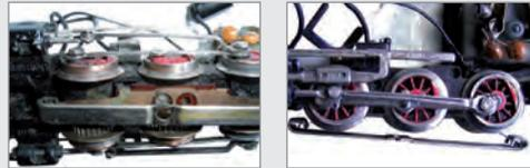
Links: Der Schleifer ist korrodiert. Rechts: Der Mittelschleifer hängt schief unter der Lok.
