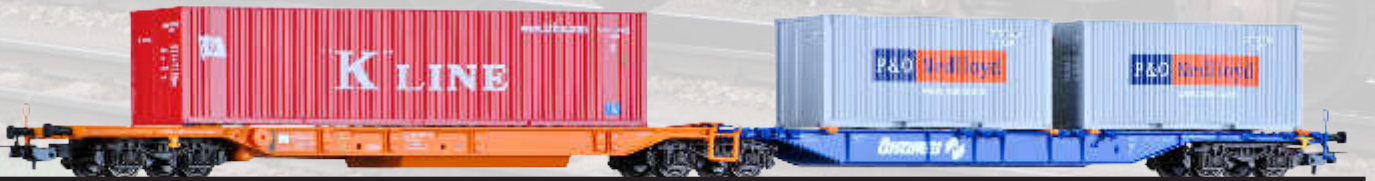
Doppeltragwagen Sdggmrs „Ökombi“ der ÖBB, beladen mit zwei 20" Container „P&O Nedlloyd“ und einem 40" Container „K Line“ Container car Sdggmrs „Ökombi“ of the ÖBB with two 20" containers "P&O Nedlloyd" and one 40" container "K Line"
