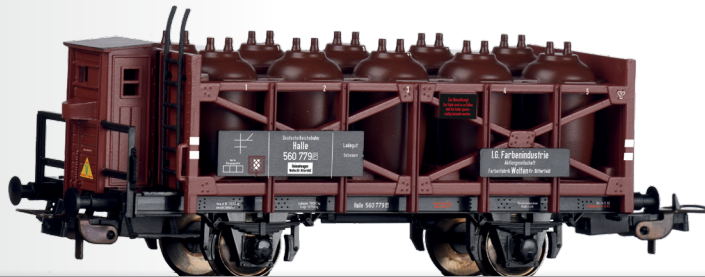
Säuretopfwagen „I.G. Farbenindustrie Leverkusen“, eingestellt bei der DRG Acid pot car „I.G. Farbenindustrie Leverkusen“ of the DRG
