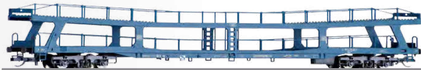
Autotransportwagen DDm 915 der DB Car DDm 915 of the DB für automobile transport
