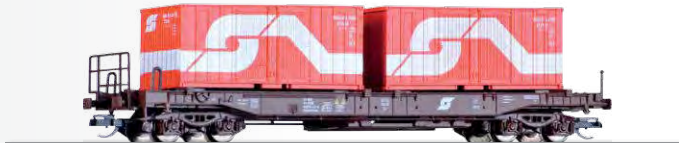
Taschenwagen Sdgmks der ÖBB, beladen mit zwei 20' Containern Pocket car Sdgmks of the ÖBB with two 20' container
