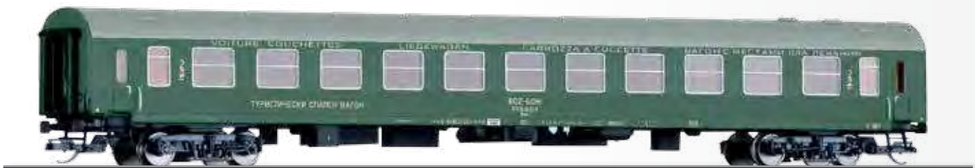
Liegewagen 2. Klasse Bcme, Bauart Halberstadt, der BDZ 2nd class couchette coach Bcme, type Halberstadt, of the BDZ
