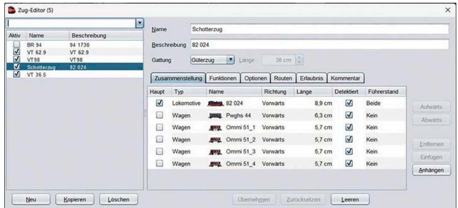
Hat man zu den Triebfahrzeugen auch Wagen erfasst, lassen sich im Zug-Editor Züge zusammensetzen. Dabei berechnet iTrain die Zuglänge, die später für die Auswahl der zu befahrenden Gleise anhand deren Länge wichtig ist. In der Spalte „Detektiert“ ist vermerkt, welcher der Wagen z.B. durch Achswiderstände oder Innenbeleuchtung vom Besetzmelder erfasst wird.
