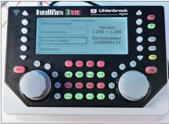
Die Intellibox 2neo wird direkt mit der aktuellen Softwareversion 1.200 ausgeliefert. Es ist nicht nötig, das Intellibox 2-Update von der Uhlenbrock-Seite aufzuspielen. Die nächsten Softwareupdates für die IB2neo betreffen nur das integrierte WLAN-Interface und werden über eine Webseite des integrierten Web-Servers eingespielt.
