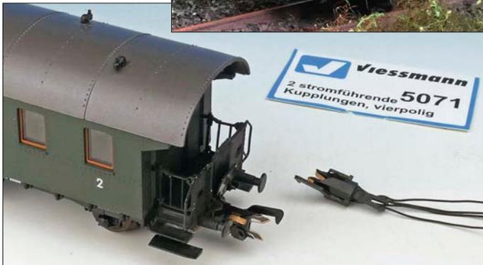
Zur Stromversorgung des Steuerwagens eignen sich stromführende Kupplungen. Zum „Durchklingeln“ der einzelnen Adern sind Multimeter oder Durchgangsprüfer unverzichtbare Hilfsmittel.
