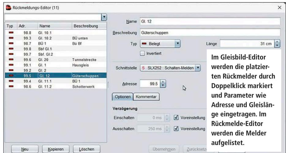
überwacht. Die Gleise sind elektrisch in entsprechende Überwachungsabschnitte einzuteilen und an die Eingänge der Besetzmelder anzuschließen.
