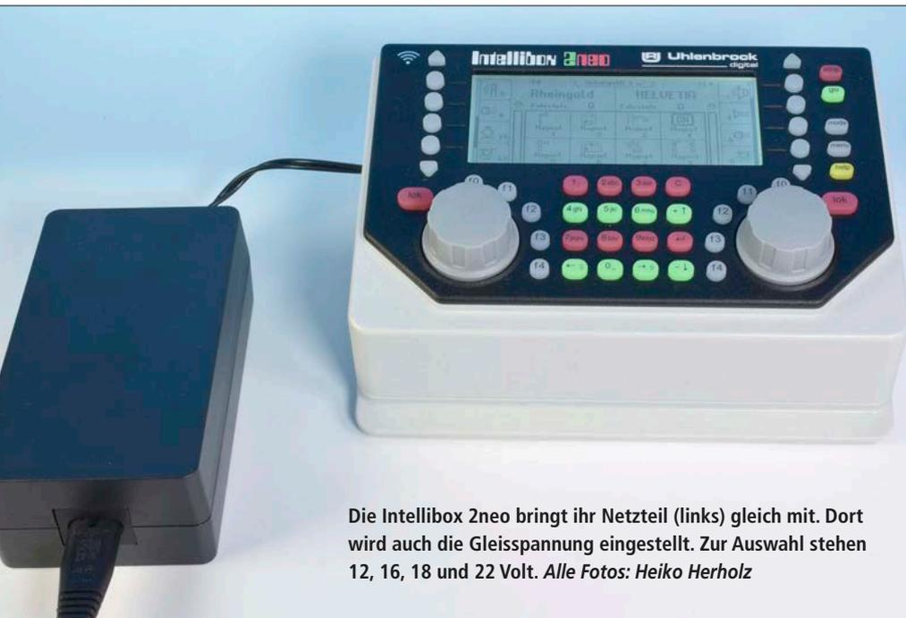
Die Intellibox 2neo bringt ihr Netzteil (links) gleich mit. Dort wird auch die Gleisspannung eingestellt. Zur Auswahl stehen 12, 16, 18 und 22 Volt. Alle Fotos: Heiko Herholz
