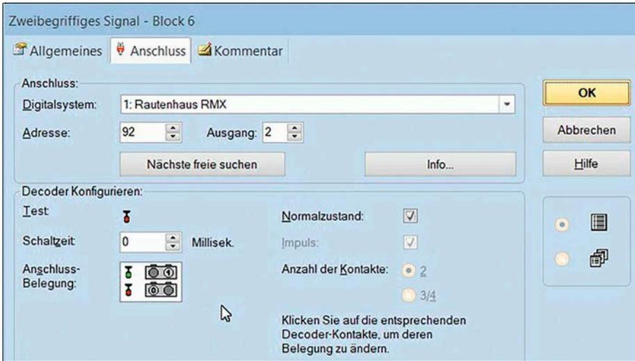
Für die Bedienung des Signals werden nach Anklicken des Signalsymbols im Gleisplan Parameter wie Adresse, Schaltzeit und Anschlussbelegung eingetragen.
