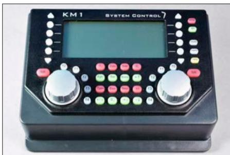
Für den Großbahnbetrieb hat Uhlenbrock der SC7 eine neue Endstufe spendiert, die bis zu 7 Ampere an das Gleis liefern kann. Etwas eigentümlich ist der Stromanschluss mit zwei Steckern.
