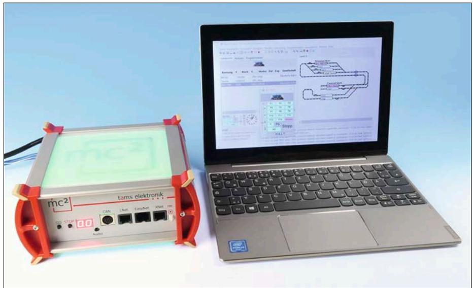
Die Digitalzentrale von Tams wird über den Netzwerkanschluss mit dem PC verbunden. Die zugehörige IP-Adresse muss dazu schrittweise über die Segmentanzeige der mc<sup>2</sup> abgelesen werden.
