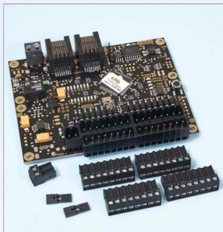
Bei der Platine handelt es sich um den Besetzmelder GBM16TS als „Lötbausatz“. Zu verlöten sind lediglich die Anschlüsse.
