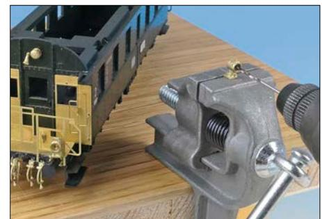
Wenn die Laternen mit SMD-LEDs funktionsfähig sein sollen, muss frühzeitig an die Löcher für die Kabel gedacht werden.
