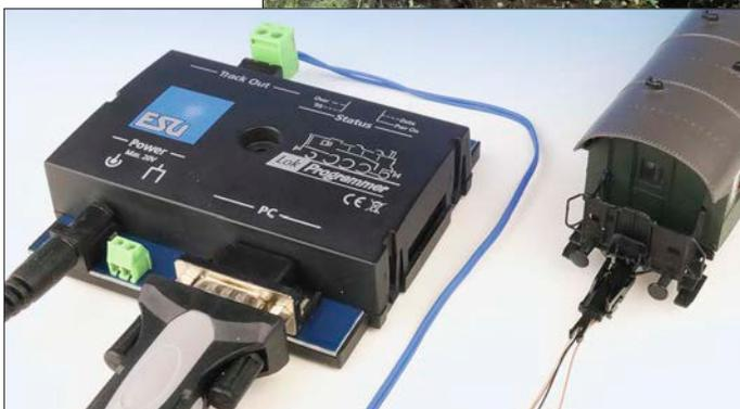
Der fix und fertig umgebaute Steuerwagen wird einzeln über die Viessmann-Kupplung mit dem LokProgrammer verbunden. Der Decoder kann danach übersichtlich am PC eingerichtet werden.
