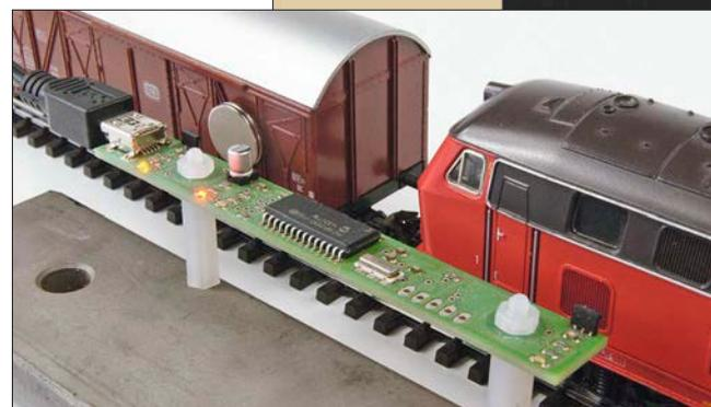
Zum Einmessen wird an der Lok oder einem angehängten Wagen ein Magnet befestigt und der zugehörige Sensor einfach neben dem Gleis platziert.
