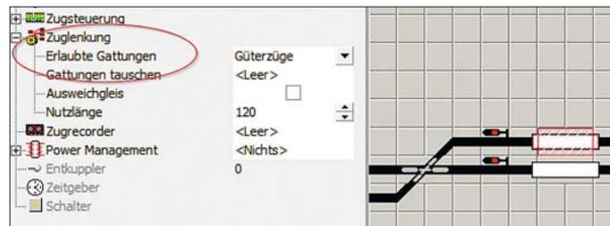
Die erlaubten Gattungen und die Nutzlängen der Gleise werden in den jeweiligen Eigenschaften der Zugzielanzeiger hinterlegt.
