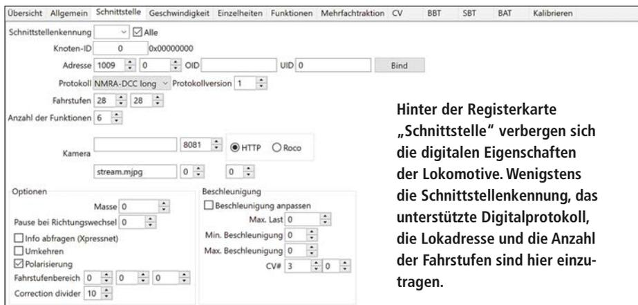
Hinter der Registerkarte „Schnittstelle“ verbergen sich die digitalen Eigenschaften der Lokomotive. Wenigstens die Schnittstellenkennung, das unterstützte Digitalprotokoll, die Lokadresse und die Anzahl der Fahrstufen sind hier einzutragen.
