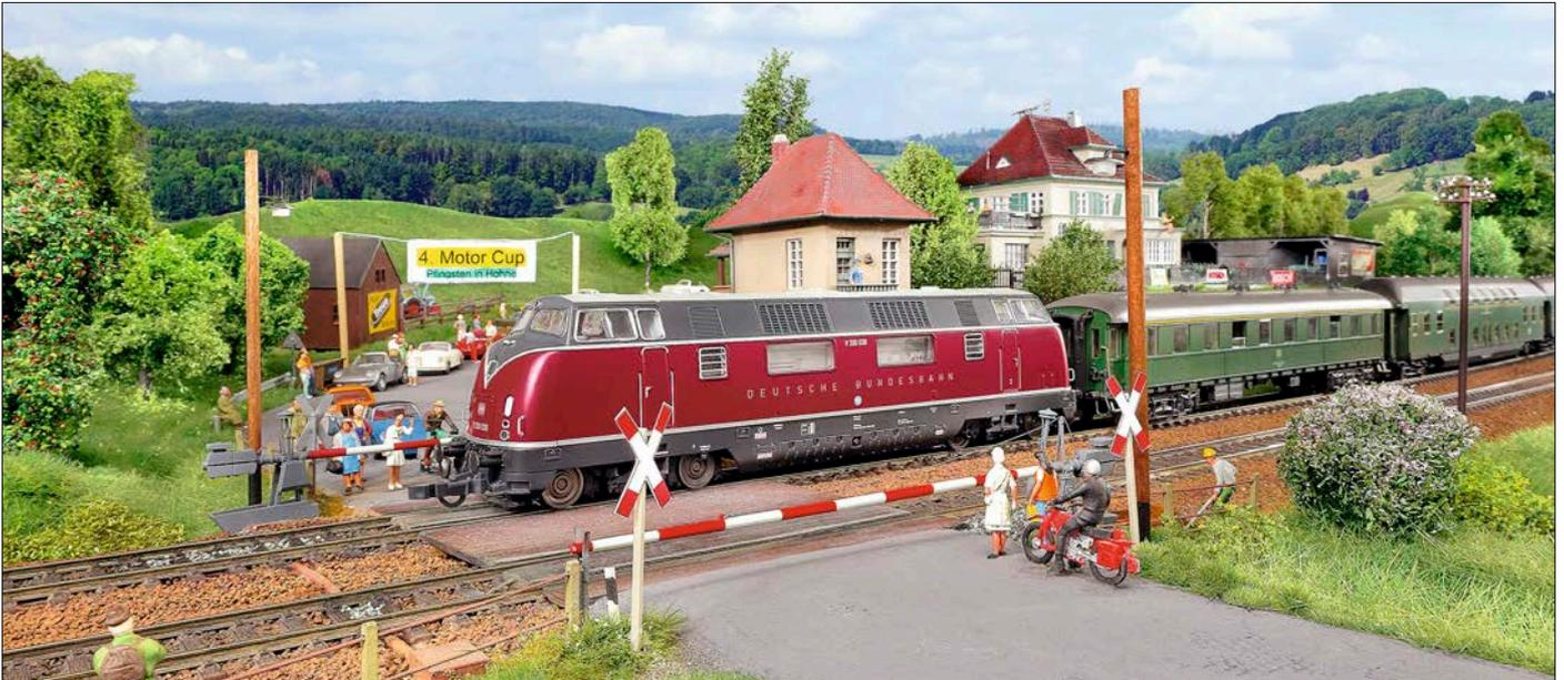
Die Automatisierung der Zugfahrten mit dem Steuerprogramm TrainController hat den Vorteil, dass sich die Schranken am Vorbild orientieren und in Abhängigkeit von der Zuglänge wieder heben.
