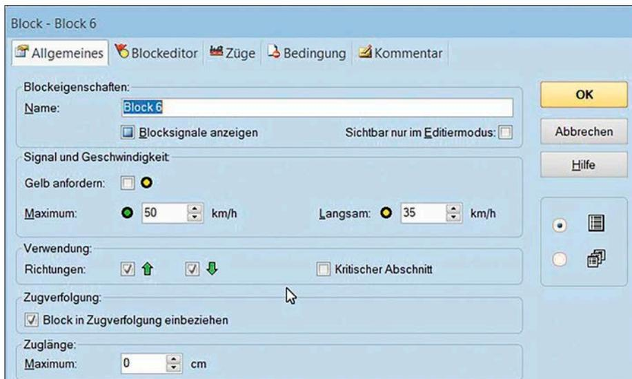
Klickt man im Editiermodus auf ein Blocksymbol, öffnet sich das zugehörige Fenster, in dem Parameter wie Geschwindigkeit, maximale Zuglänge, Haltepunkte usw. unter den verschiedenen Reitern des Blocks eingetragen werden können.
