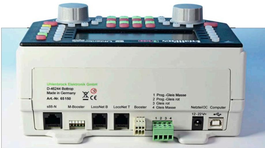
Die Rückseite der IB2neo zeigt etwas deutlicher den Unterschied zum Vorgängermodell IB2. Bei dieser erfolgte die Stromversorgung über zwei Schraubklemmen neben dem Gleisausgang, was leider oft zu Verwechslungen und Beschädigungen führte. Das ist nun vorbei, da das mitgelieferte Netzteil unverwechselbar an einer gesonderten Buchse angeschlossen wird. Die neue s88-N-Buchse ist so weit wie möglich von den LocoNet-Buchsen entfernt, um auch hier Verwechslungen zu verhindern.
