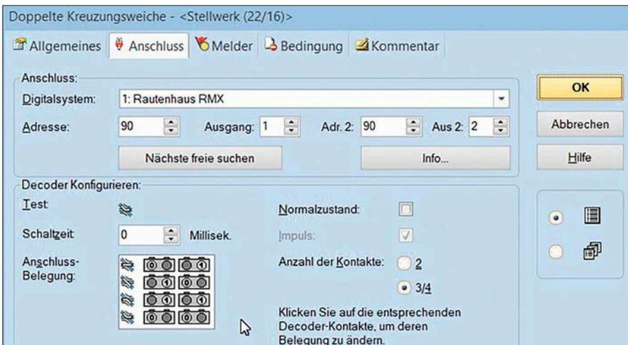
DKWs können wahlweise mit einem oder zwei Antrieben eingerichtet werden. Trickreich ist die Zuordnung der Anschlussbelegung für die korrekte Lage der Weichenzungen bei zwei Antrieben.
