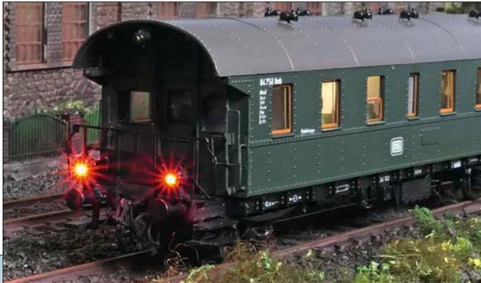
chen Schlusslicht-LEDs in den unteren Laternen verfahren wir genauso. Das Schlusslicht erhält einen eigenen Ausgang am Funktionsdecoder, der notwendige Vorwiderstand für die Reihenschaltung der roten LEDs besitzt einen Wert von 6,8 k $\Omega$ .
