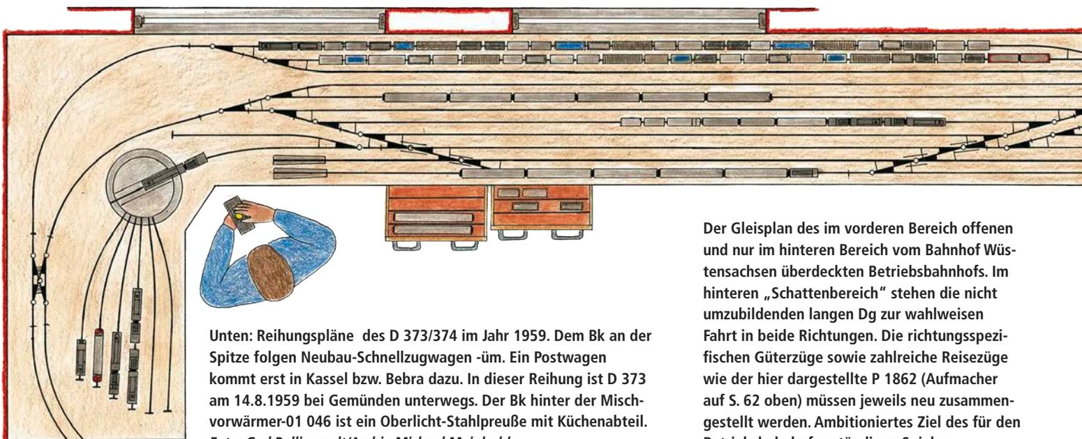
Der Gleisplan des im vorderen Bereich offenen und nur im hinteren Bereich vom Bahnhof Wüstensachsen überdeckten Betriebsbahnhofs. Im hinteren „Schattenbereich“ stehen die nicht umzubildenden langen Dg zur wahlweisen Fahrt in beide Richtungen. Die richtungsspezifischen Güterzüge sowie zahlreiche Reisezüge wie der hier dargestellte P 1862 (Aufmacher auf S. 62 oben) müssen jeweils neu zusammengestellt werden. Ambitioniertes Ziel des für den Betriebsbahnhof zuständigen Spielers ...
