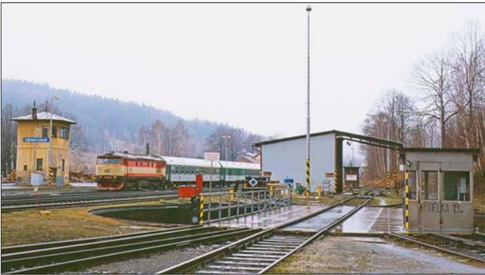
Der Blick aus dem Bw in den Bahnhof. Die Zu- führung zur Drehscheibe führt durch die Überdachung der Dieseltankstelle. Vor der Modernisierung der Bahnanlagen befand sich am Ende der Lade- straße noch ein Stell- werk für die westliche Bahnhofsausfahrt. Foto: Slg. Koch
