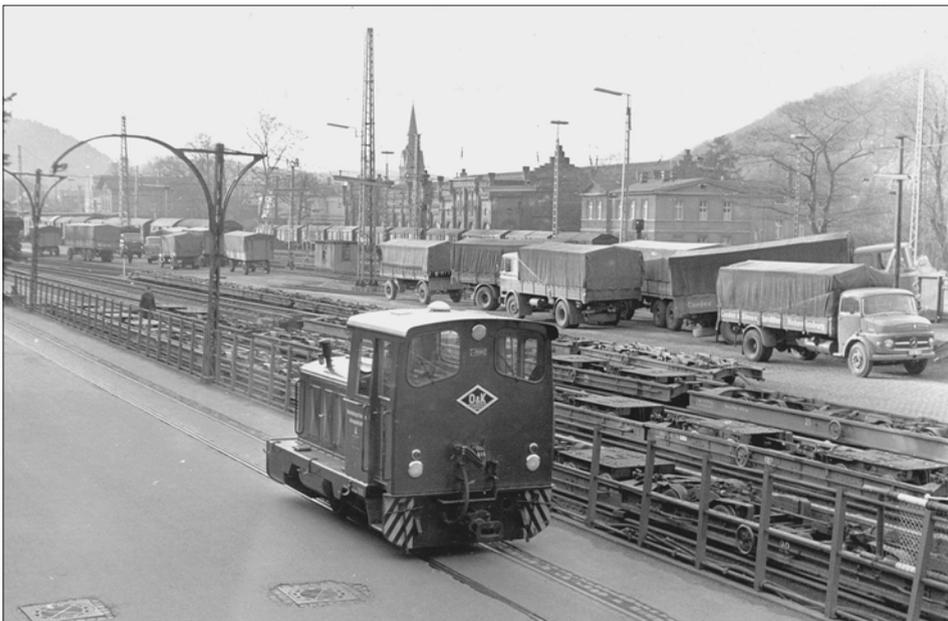
Die kleinen Diesel-B-Kuppler mit außenliegender Blindwelle bewährten sich trotz lediglich 140 PS Leistung ausgesprochen gut. Sie waren mit einer einfachen pneumatischen Mehrzugsteuerung ausgestattet, sodass zwei Maschinen von einem Lokführer bedient werden konnten. Diese „Doppeltraktion“ kam vergleichsweise häufig zum Einsatz, denn sie war bei mehr als drei zweiachsigen Einzelwagen oder ab zwei Drehgestellwagen erforderlich.
