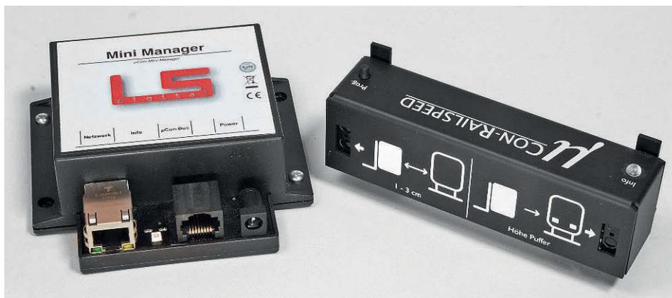
Das  $\mu$ Con-Railspeed-Messgerät besteht aus der  $\mu$ Con-Railspeed-Einheit und dem Mini-Manager. Dieser wird per LAN mit dem PC verbunden.
