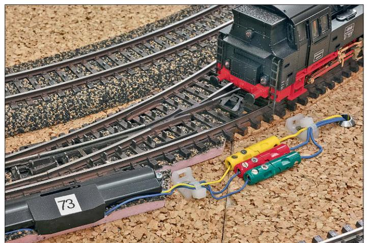
Die magnetischen Weichenschaltantriebe sind im sogenannten Schattenbahnhof oberirdisch angebracht und mittels Stecker bequem tauschbar.
