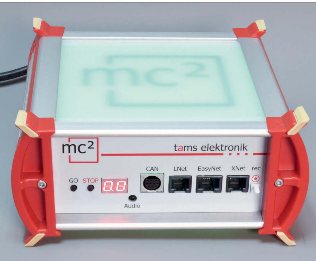
Die Plexiglasscheibe an der Oberseite ist mit der Bezeichnung mc<sup>2</sup> hinterdruckt. Die RGB-Beleuchtung illuminiert das Logo entsprechend des Betriebszustands grün oder rot.
