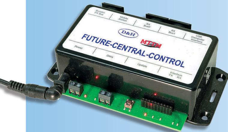
Die FCC ist eine kompakte Zentrale ohne Bedienelemente für den Betrieb. Sie verfügt über ein eingebautes USB-Interface sowie eine Anschlussmöglichkeit für eine Trix mobile station. Die FCC unterstützt den Multiprotokollbetrieb mit Selectrix, Selectrix-2, DCC und Motorola. Letzteres bietet für den hier betrachteten Anwendungskontext keinen Mehrwert.
