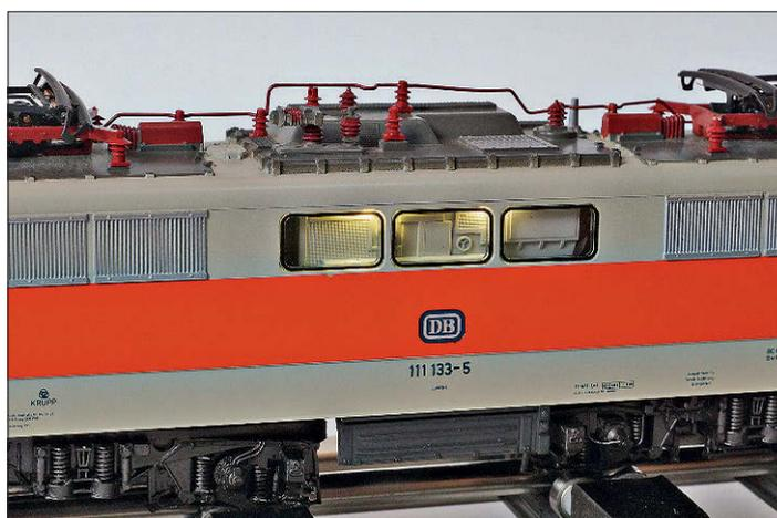
Die Beleuchtung des Maschinenraums sollte nicht zu hell sein. Die Feinabstimmung der Helligkeit erfolgt über den ESU-Lokprogrammer. Man kann die Lichtfunktion aber auch so einrichten, dass sie nur im Stand der Lok eingeschaltet werden kann.
