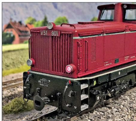
Fährt die Lok Lz, genügt das vereinfachte Zugschluss-signal Zg5: Nur die rechte Lampe leuchtet rot (was übrigens beim Vorbild über farbige Vorsteckscheiben realisiert wurde). Die Funktion wird über F5 aktiviert.
