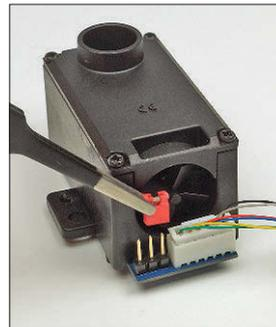
Die Umstellung der Betriebsart erfolgt mit einer kleinen Steckbrücke auf der Steuerplatine des Raucherzeugers.
