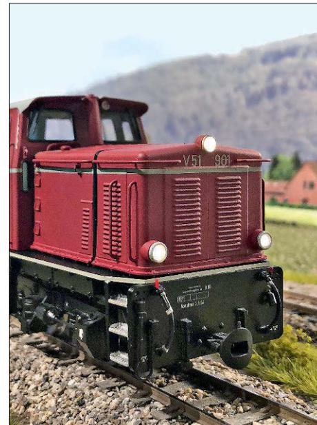
Nun kann endlich der Fahrspaß beginnen. Durch Drücken von F1 starten die Motoren mit rund fünf Sekunden Abstand in den Leerlauf über. Dann wird mit F0 klassischerweise die Stirnbeleuchtung eingeschaltet. Entsprechend der Schalteranordnung geht das weiße Licht links unten sofort an, das Licht oben am Vorbau folgt 200 mS später und die Lampe rechts unten weitere 200 mS später.
