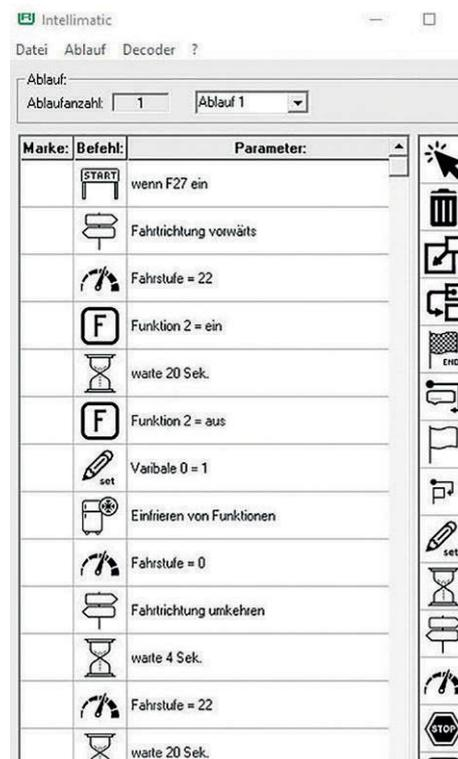
**Individuelle Automaten bietet Uhlenbrocks Intellimatic. Die dafür benötigten CVs bringt Uhlenbrock in einer eigenen Speicher-Bank unter. Die Konfiguration kann bequem mit dem Digitest erfolgen.**
