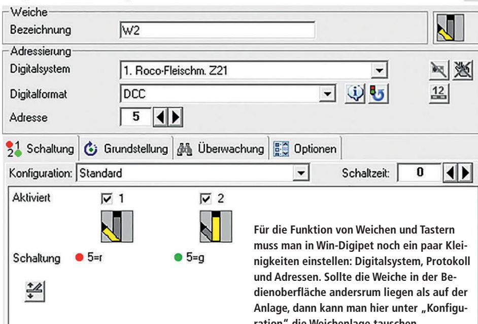
Für die Funktion von Weichen und Tastern muss man in Win-Digipet noch ein paar Kleinigkeiten einstellen: Digitalsystem, Protokoll und Adressen. Sollte die Weiche in der Bedienoberfläche andersrum liegen als auf der Anlage, dann kann man hier unter „Konfiguration“ die Weichenlage tauschen.
