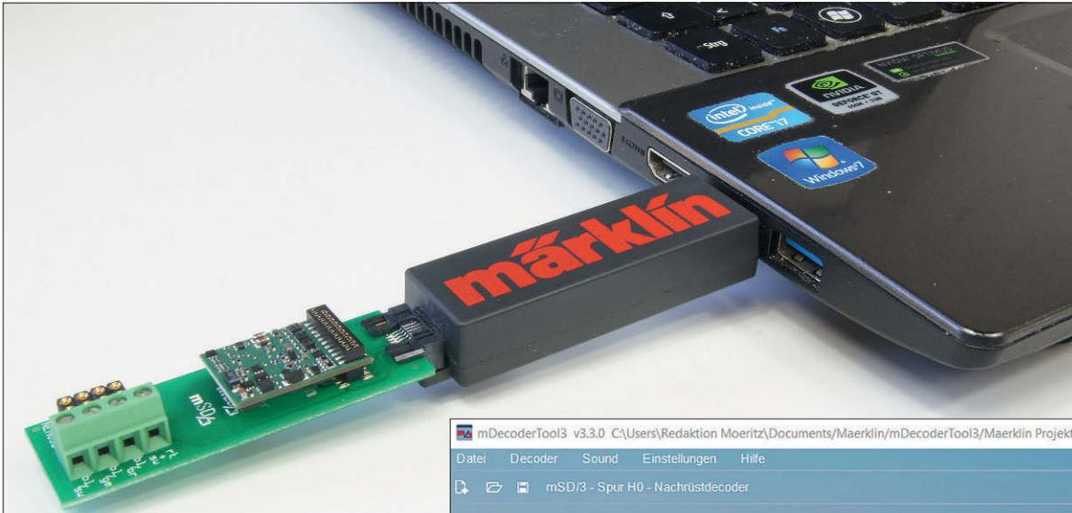
Eingesteckt am USB-Anschluss des PCs nimmt der Märklin-Decoder-Programmer den zu programmierenden hauseigenen Digitaldecoder direkt auf.
