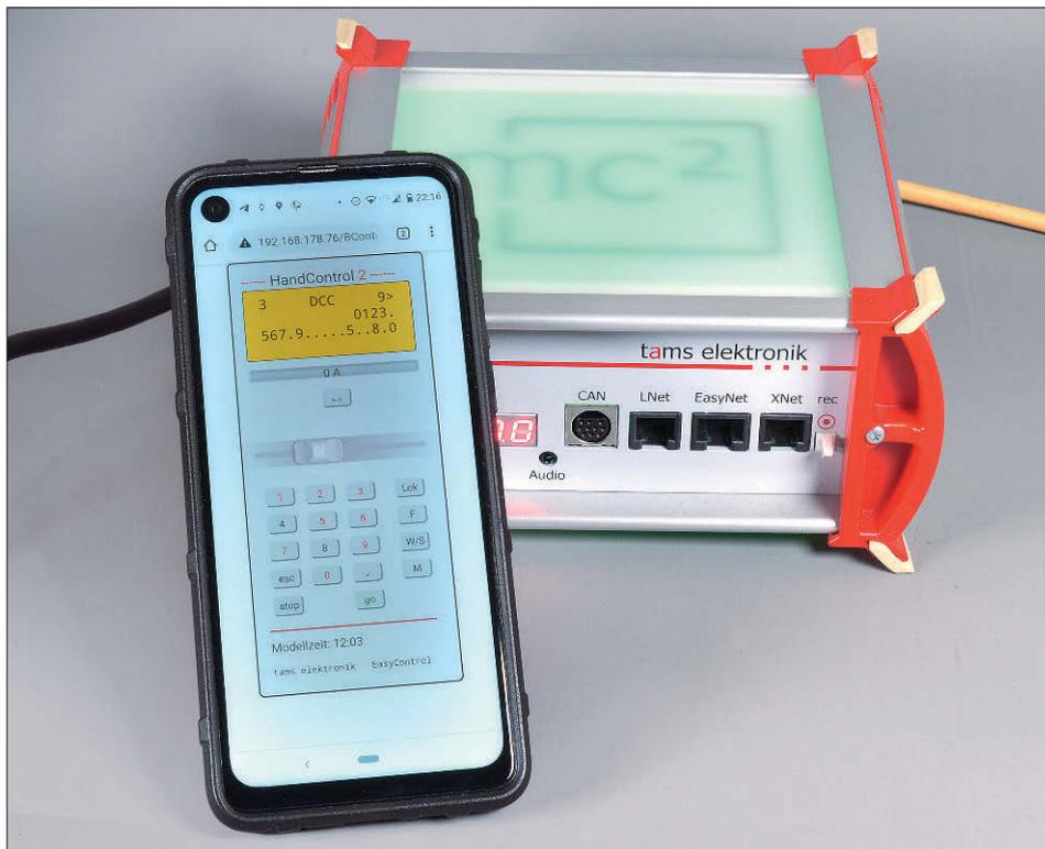
SmartController light und Freds aller Art. Es funktionieren sogar die älteren Fremo-Freds mit drei Tasten. Hier hat Tams etwas Energie in die Programmierung gesteckt, um das anspruchsvolle Zeitverhalten der Handregler zu unterstützen. Der Anschluss weiterer LocoNet-Geräte wie Rückmelder wird zu einem späteren Zeitpunkt folgen.
