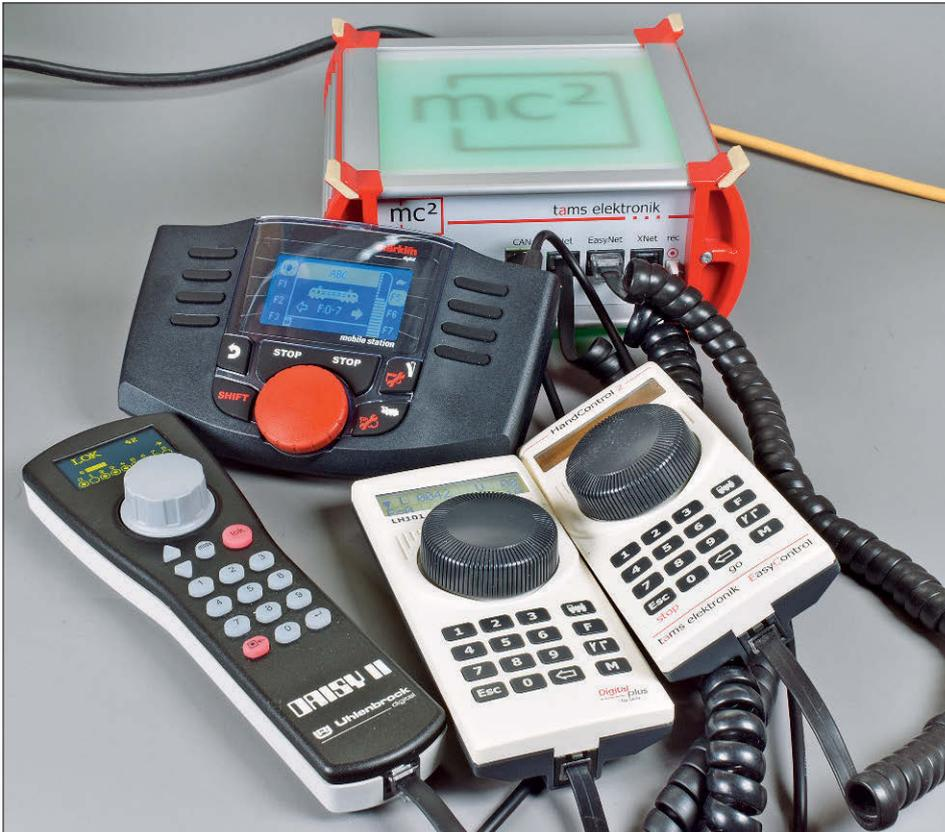
Die mc<sup>2</sup> im Kreise der möglichen Handregler. Dazu gehört die Mobile Station 2 von Märklin ebenso wie Uhlenbrocks Daisy II. Tams benutzt für seinen Handregler HC2 das gleiche Gehäuse wie Lenz für den LH101. Beide lassen sich problemlos an der mc<sup>2</sup> betreiben.
