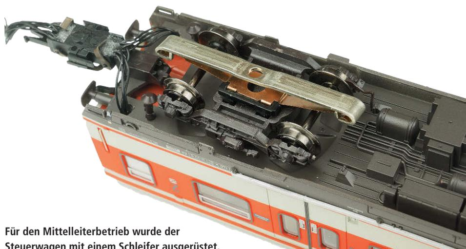
Für den Mittelleiterbetrieb wurde der Steuerwagen mit einem Schleifer ausgerüstet.
