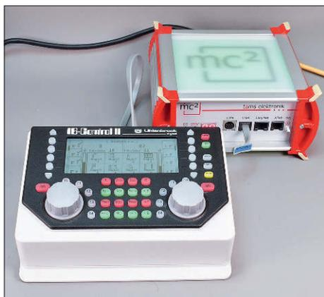
Die IB-Control II wird auch an der mc<sup>2</sup> ein mächtiges Eingabewerkzeug. Die Intellibox II verfügt über ein Slave-Modus und verhält sich in diesem genauso wie die IB-Control II.
