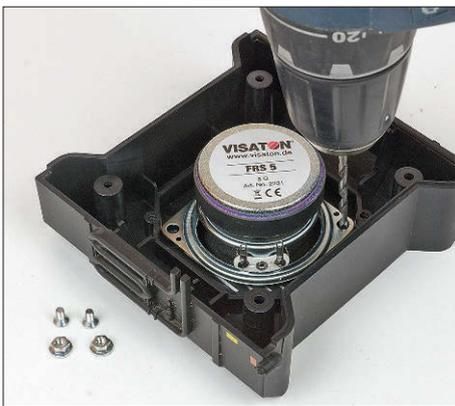
Der 50-mm-ESU-Lautsprecher mit einer Impedanz von 8  $\Omega$  stammt aus dem Hause Visaton und sorgt in Verbindung mit der Class-D-Audioendstufe des Decoders für eine eindrucksvolle Geräuschkulisse. Die Montage erfolgt im Kunststoffgehäuse zwischen den Drehgestellen – also quasi im Tank.
