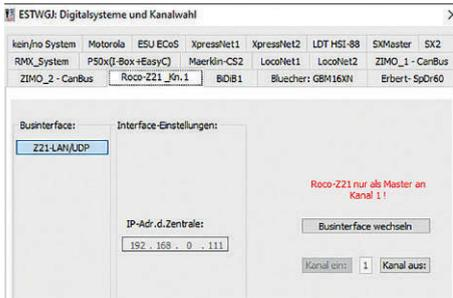
Die Konfigurationseinstellungen für die Z21 sind in ESTWGJ schnell gemacht: Es muss lediglich im Fenster „Digitalsysteme und Kanalwahl“ die IP-Adresse eingegeben werden.
