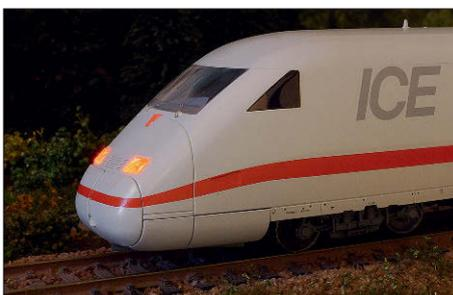
Der ICE macht mit der Innenbeleuchtung von ESU eine Menge her. Auch der Lichtwechsel am Steuerwagen wird vom Funktionsdecoder der Wagenbeleuchtung gesteuert.
