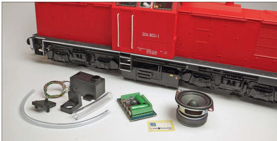
Die Komponenten für die digitale Nachrüstung kommen von ESU. Rechts der Digitaldecoder vom Typ SoundPilot 5 XL und der 50-mm-Lautsprecher. Auf der linken Seite liegt der große XL-Raucherzeuger für den Dieselrauch samt Adapterpaket für Dampf- oder Dieselbetrieb bereit.
