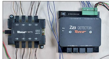
„Digitales Testfeld“ – die kleine N-Anlage verfügt zwar über keine physikalischen Signale, aber in der Praxis sind die verbauten Entkuppeler oft schwieriger einzubinden. Die Anlage ist mit einem Roco-Decoder und einem railcomfähigen Detector 10808 ausgestattet.
