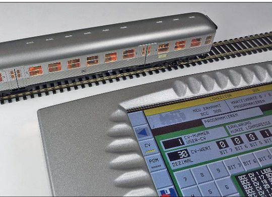
Viessmann bietet seine digitalen Wageninnenbeleuchtungen in weißer, warmweißer und gelbe Lichtfarbe an. Ein optionaler Stützkelco sorgt für einen flackerfreien Betrieb. Bei dem Silberling kommt eine Beleuchtung mit warmweißen LEDs zum Einsatz. Auf den Sitzplätzen des DB-Klassikers haben bereits einige Reisende Platz genommen.
