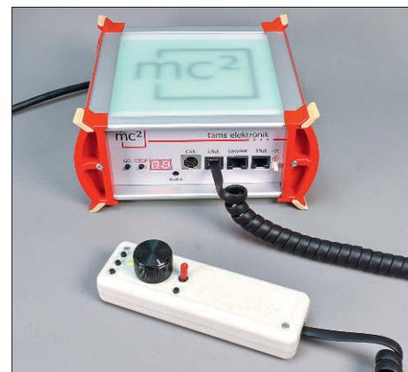
An der mc<sup>2</sup> funktionieren alle Varianten des FRED, auch die älteren mit drei Funktionstasten. Da die mc<sup>2</sup> auch das Purgung beherrscht, steht dem Fremo-Einsatz nichts im Weg.
