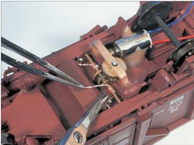
„Mit chirurgischer Präzision“ wird der dünne Faden mehrfach um die 1-mm-Welle gewickelt und am freien Ende festgeklebt. Umlenkstifte (ebenfalls 1-mm-Draht) führen den Faden.
