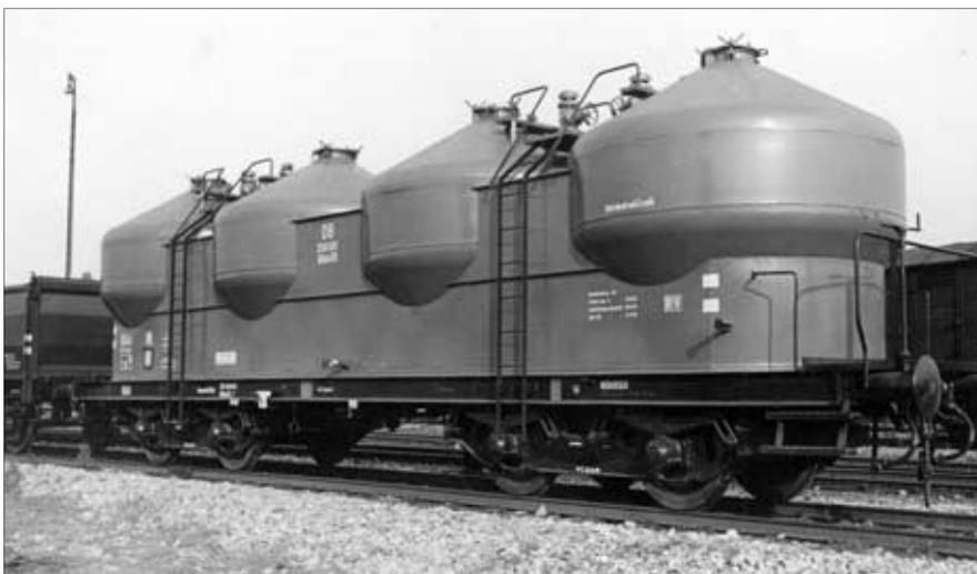
durch besondere Auslassöffnungen abfließen kann. Da diese durch drehbare Schieber abgeschlossen sind, ist wie beim Hubkipper eine Regelung des Ausströmvorgangs möglich.
