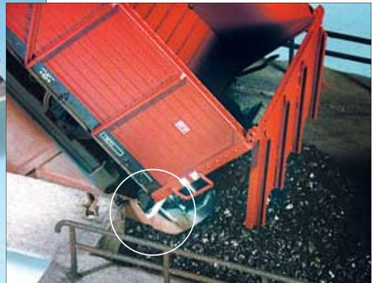
Die Kunst besteht darin, Martin Knadens Wagen (s.S. 60) möglichst spät zu öffnen, damit die gesamte Ladung auch den Bunkertrichter erreicht. Die Trittstufe entriegelt die Stirnwand, aber erst sollen die Federpuffer durch den Schub des Waggons eingedrückt sein. Also muss man den Anschlag für die Trittstufe sorgfältig justieren. *Kipper-Modell und Fotos: Bertold Langer*
