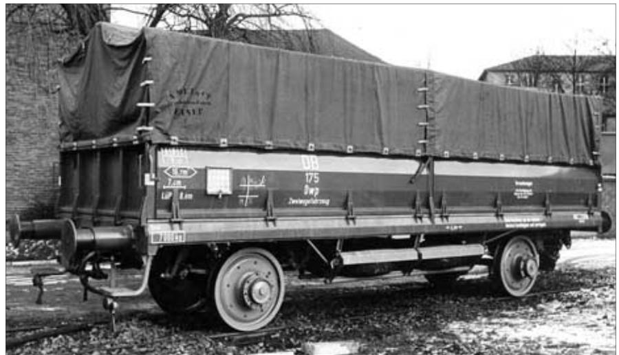
Der Owp (01) 176 von Schöttler hatte unter der Lkw-Pritsche zwei zur Wagenmitte schwenkbare luftbereifte Achsen, vor die für den Schieneinsatz externe Einachs-Kopfstücke mit Eisenbahn-Radsätzen geschraubt wurden. Auf der IAA 1953 in Frankfurt/M wurden beide Owp ausgestellt. Fotos: Helmut Oesterling/Archiv Michael Meinhold
