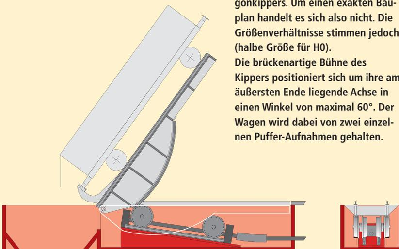
Ein Einachs-Wagen wird auf einer geneigten Gleisbahn durch eine Spindel nach oben transportiert. Auf einer Achse sind jeweils ein Paar fester und loser Modellbahnräder montiert (innen lose, außen fest mit der Achse verbunden); die äußeren Räder heben die Bühne mittels der Rollbahn, die von der unteren Kante der Brücke gebildet wird.
