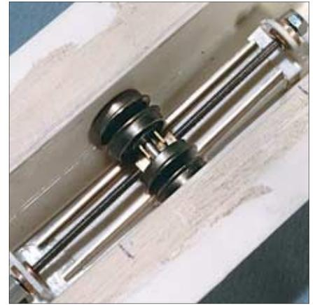
Die Aufnahme für die Wagenachse: zwei rechtwinklig aufeinander geklebte Messing-U-Profile, auf dem unteren zwei Muttern aufgelötet, aber nur eine davon noch mit Gewinde.
