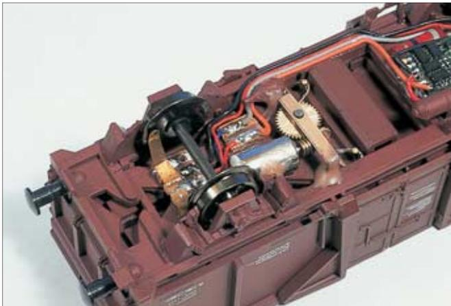
Die Stromabnahmebleche erhalten eine eingeprägte Mulde um die Reibung am Rad zu minimieren. Die Federkraft darf zudem nicht zu groß sein, sonst blockiert der ganze Radsatz.
