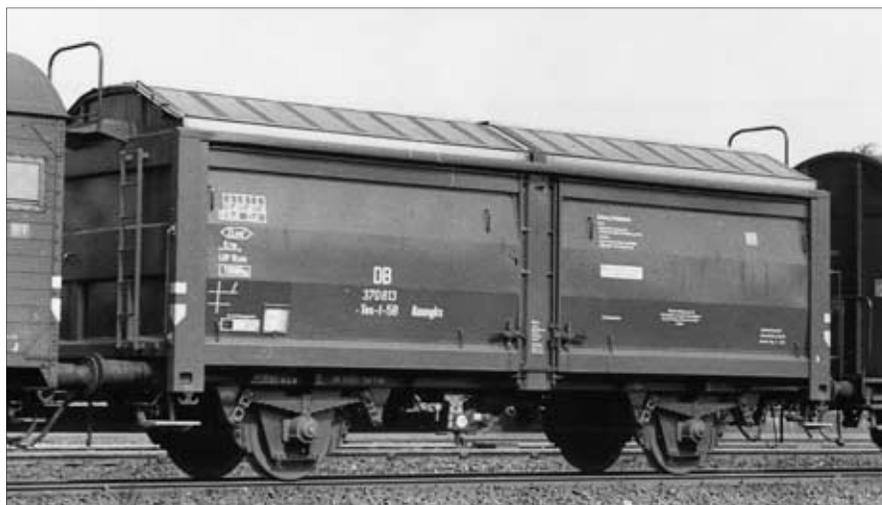
Gleichfalls ein Wagen der ersten Bauserie ist dieser Klmmgks 66, dessen geöffnete Seitenwände und Dachteile die auch in den obigen Skizzen dargestellten vielfältigen Möglichkeiten der Be- und Entladung augenfällig demonstrieren. Lediglich die besonders stabil ausgeführten Stirnwände geben dem Wagenkasten die notwendige Steifigkeit. Archiv Michael Meinhold
