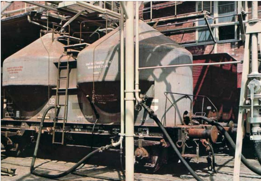
Auch diese Aufnahme eines Kds 54 wurde für eine Werbekarte der DB angefertigt. Beim Transport von Staubgütern war die DB besonders heftiger Konkurrenz der Straße ausgesetzt und entwickelte daher schon früh Wagen wie den darunter abgebildeten KKds 55 zum Transport von Tonerde. 1954 wurden 24 dieser Vierachser gebaut. Ganz unten: Zement-Umschlag Schiene/Straße; der Lkw ist ein umgebauter GMC der US-Army. Archiv Michael Meinhold
