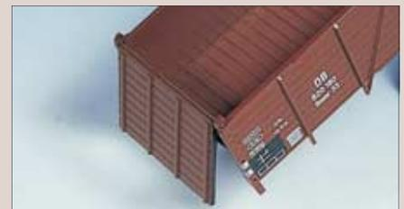
In den Wagenboden werden zwei Aussparungen für Magnete eingefeilt. Für unser Muster wurde ein winziger Magnet vom Faller-car-System halbiert
