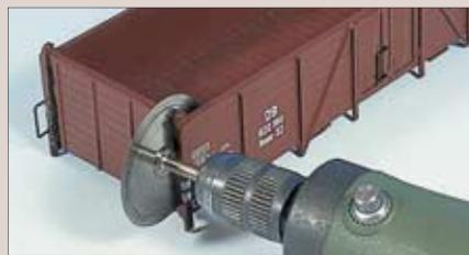
Der Umbau beginnt nach dem Trennen von Fahrwerk und Aufbau mit dem Herauslösen der Stirnwand. Damit der Spalt möglichst schmal wird, sollte hierzu ein nur 0,1 mm dünnes Kreissägeblatt der Minibohrmaschine verwendet werden. Der Sägeschnitt liegt exakt neben den Ecksäulen des Wagenkastens. Auf der Unterseite muss man „Pi-mal-Daumen“ einen guten Millimeter von der Kante entfernt ansetzen.
