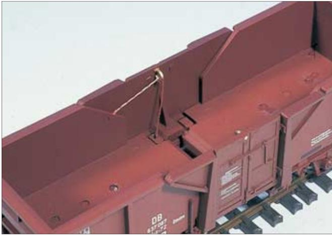
Die Kraft des Motors wird über dünne, geschmeidige Fäden auf die Wagenkastenhälften übertragen. Durch Verdrehen dieser Umlenkösen lässt sich die Hubmechanik in Grenzen sogar justieren.
