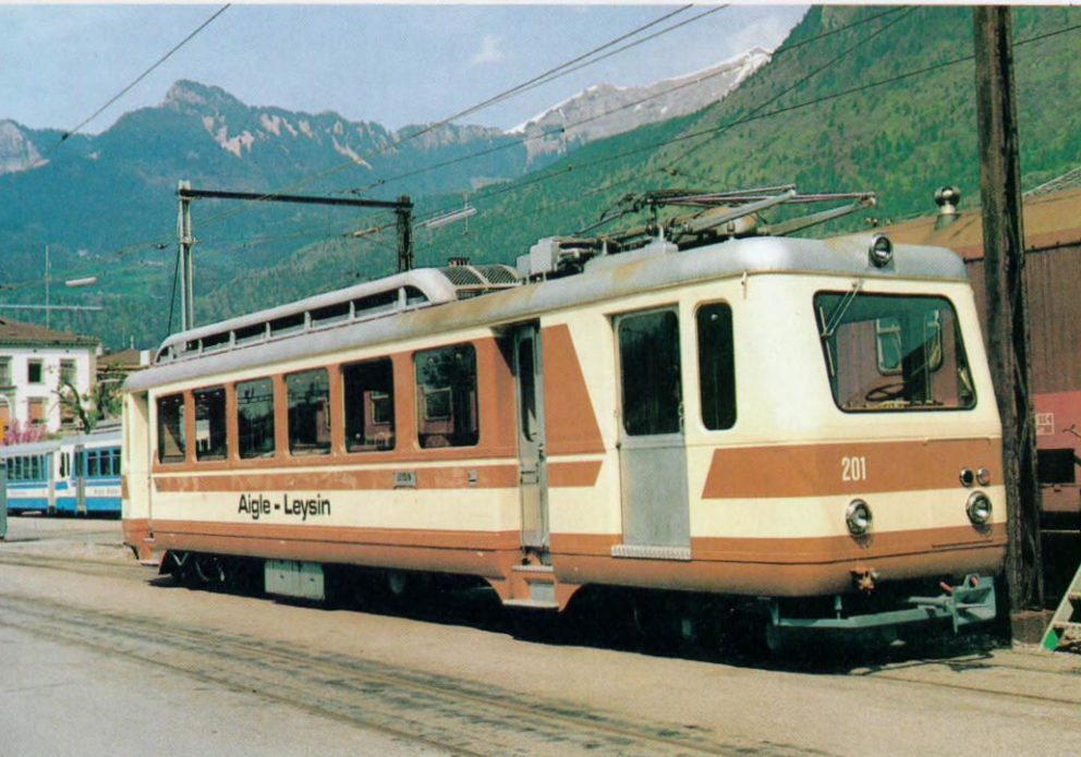
▲ Der Triebzug BDeh 2/4 201 der AL auf dem Bahnhofsvorplatz von Aigle. Er ist sowohl für Adhäsions- als auch für Zahnradbetrieb geeignet.
