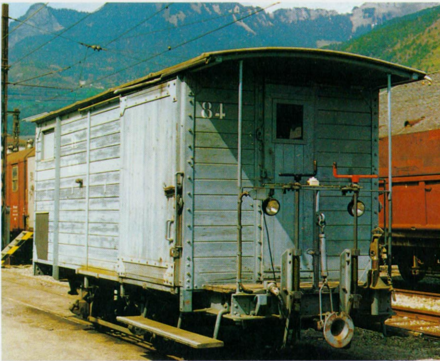
▲ Dieser alte Güterwagen der AL hat wohl schon bessere Tage gesehen, aber immerhin steht er noch im Einsatz. Die rote Kurbel bremst das Bremszahnrad.
