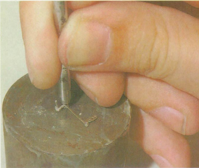
▲ Filigranarbeit: Das Nieten der Steuerung. Körner und kleiner Amboß erleichtern die Arbeit.
