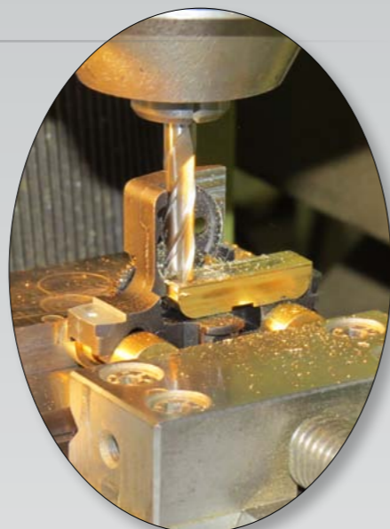
Fräsarbeiten an einem Märklin-Drehgestell. Foto: Manfred Merz
