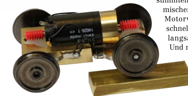
Pendelachs-Fahrwerk in Spur 0 und H0 möglich. Foto: Manfred Merz
