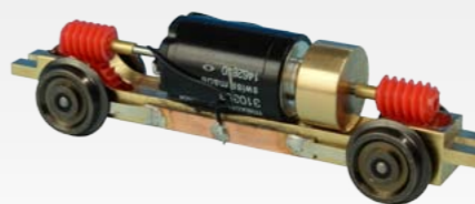
Fahrwerk (H0m), Achsstand 36,8 mm
