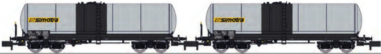
Set de 2 citernes ANF longues "SIMOTRA" Bogies Y 25S, n°33 87 784 9 642-6 et n° 33 87 784 9 646-7 Transport d'engrais liquides - Époque V NW-241
