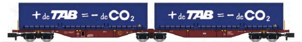
Wagon Sggmrss90 TOUAX + 2 caisses mobiles de 45' à parois bâchées "TAB - de CO 2 " - Époque V-VI - NW-205
