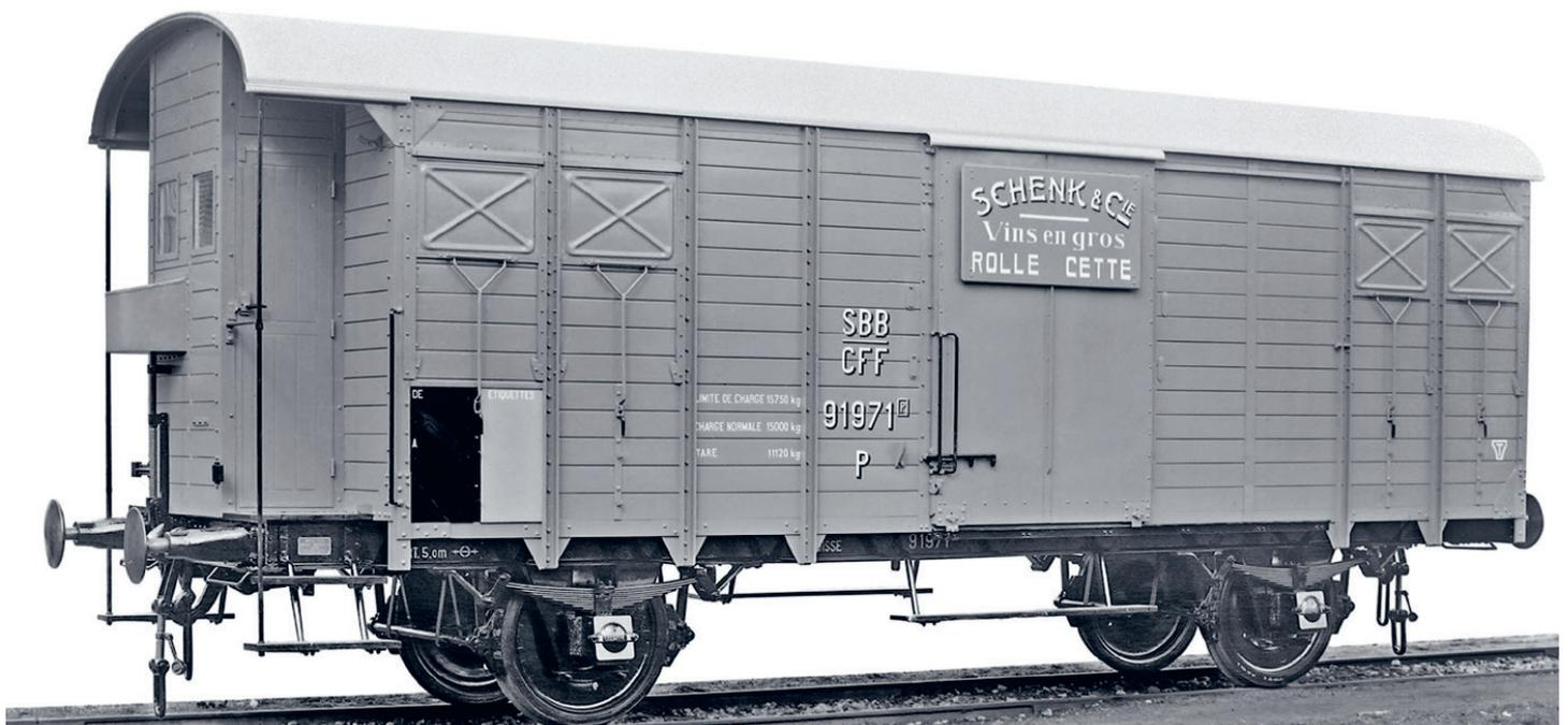
Ab 1913 beschaffte die SBB neue Standard-Güterwagen mit fünf Meter Achsstand, welche als K3 bezeichnet wurden. Diese Güterwagen wurden bis 1950 in über 4400 Exemplaren gebaut. Mit der ursprünglichen Stahltüre, den genieteten Kastenprofilen und dem Segeltuchdach waren sie bis Mitte der 1950er-Jahre anzutreffen.
