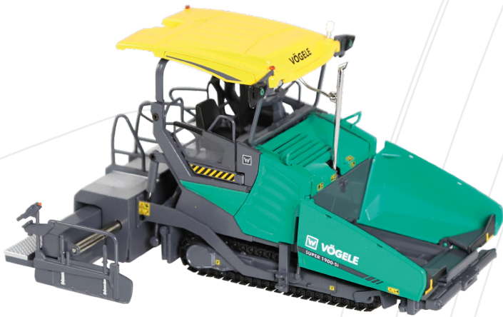
Vögele Super 1900-5i Straßendeckenfertiger / Tracked paver
