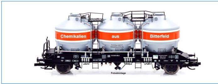
2-achsiger Silowagen Bauart Zk der DR (Epoche IV) Chemikalien aus Bitterfeld, 2. Betriebsnummer NW 52111 DC 2L TT 55,90 €
