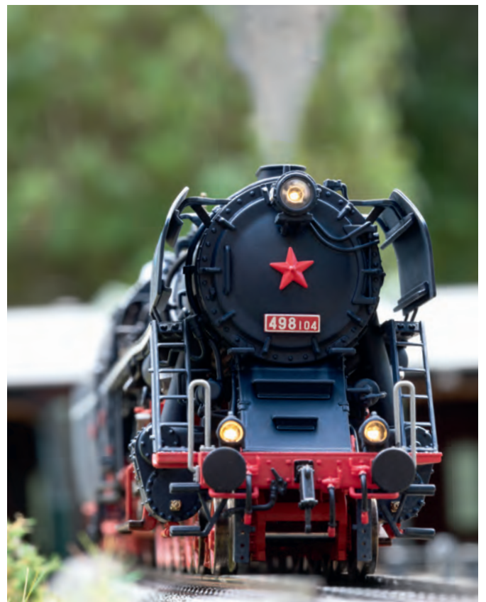
Ein Rauchgenerator mit radsynchronem Dampfausstoß sorgt für vorbildgerechtes Fahrvergnügen in H0.
