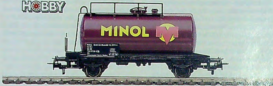
4428 Tankwagen. 2000l. Messelwagen der Deutschen Bundesbahn (DB) der ehemaligen DDR. Metallmodell der Firma M. A. Berlin. RELEX-Kupplungen. Länge über Puffer 11,5 cm. Gleichstrom-Radsatz 70 053
