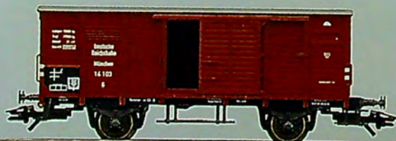
4877 Gedeckter Güterwagen. G 10 ohne Bremserhaus der ehemaligen Deutschen Reichsbahn-Gesellschaft (DRG). Schiebetüren zum Öffnen. Kurzkupplungen mit Kulissenführung. Länge über Puffer 11,0 cm. Gleichstrom-Radsatz 70 027
