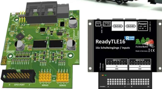
**N-H0:** Das ReadyServo8 für das BiDiB-System von Fichtelbahn weist neben den acht Servoanschlüssen noch acht GPIO-Ports auf. Das Modul ReadyTLE16 ermöglicht Rückmeldungen beim OpenCar-System.
