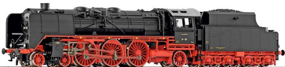
**N:** In der Ausführung der Epoche II kommt die 01 mit großen Windleitblechen, geänderter Pumpenanordnung und einem Tender der Bauart 2' 2' T 32.
