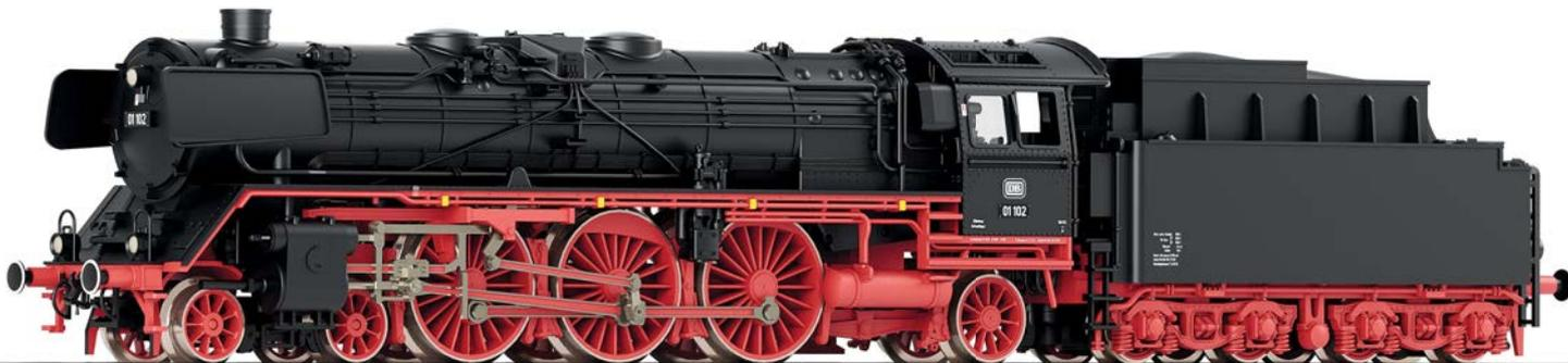
**N:** Als komplette Neukonstruktion erscheint bei Fleischmann das Modell der Baureihe 01; die DB-Ausführung der Epoche III mit kleinen Witte-Windleitblechen ist mit einem geschweißten Tender der Bauart 2'2' T 34 gekuppelt.
