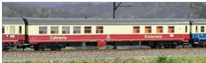
**N:** Neu im Minitrix-Programm ist der zum Kinderlandwagen WRtmh 136 umgebaute Speisewagen mit Steildach und Kuckuckslüftern.
