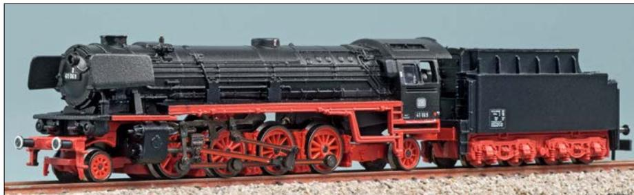
**Z:** Die DB-Neubaukessel-41er wird mit Kohlentender und lokführerseitiger Indusi ausgeliefert.
