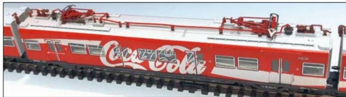
**N:** Arnolds ET 420 erhält einen Mittelwagen mit zwei Pantographen.
