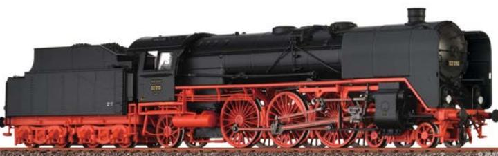
**H0:** Als weitere 2'C1'-Schleppenderlok kommt von Brawa die 02 der DRG mit Vierzylinder-Verbundtriebwerk.
