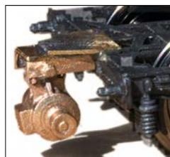
**H0:** Lichtmaschine für Drehgestelle von CN-Modell
