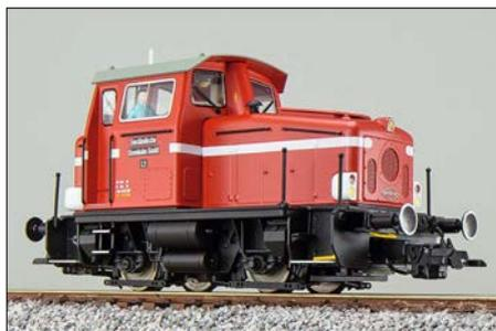
**H0:** Den zweiachsigen Deutz-Rangierdiesel bietet ESU in den Ausführungen der Regentalbahn (mit Schneepflugscharen) und der Emländischen Eisenbahn (mit geänderter Pufferbohle) an. Das Modell der V 60 kommt in der Lackierung als Lok 5 der Post.
