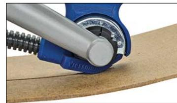
**Fräsaufsatz von Viessmann für die Proxxon-Langhalswinkelbohrmaschine zum Fräsen der passenden Rillen für das Magnetband**
