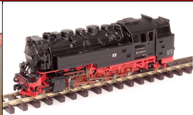
Antrieb auf 5 Achsen, Stromabnahme 6 Räder, Glockenankermotor mit Schwungmasse, 3-Licht Spitzensignal vorn und hinten, mit der Fahrrichtung wechselnd, analoges Modell, keine Digitalschnittstelle. Empfohlener Mindestradius 195 mm.
