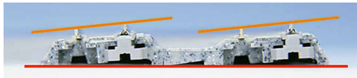
Doppelgleis mit Betonschwellen und überhöhter Schienenführung
