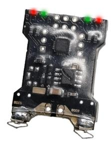
Ich bin der **DCC-Pola**, eine kleine Baugruppe mit 4 LEDs zur Anzeige der richtigen Polarität auf Ihrem Gleis **und ab heute als Fertiggerät.**
