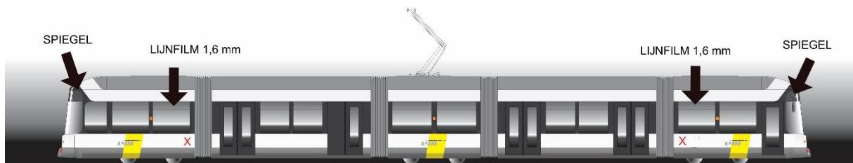
Breng aan de voor- en achterkant de lijnfilm (met bestemming naar keuze) met een breedte van 1,8 mm aan met dubbelzijdige transparante kleefband (bv. Tessa 4965) in het daarvoor voorziene lijnfilm vak.
