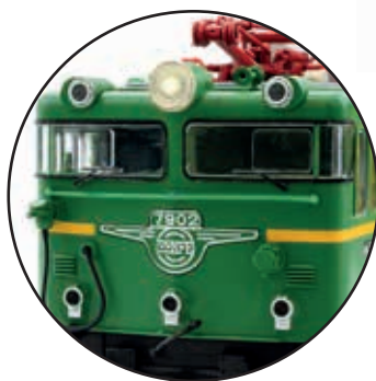
Luces frontales con foco superior independiente
