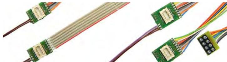
Schnittstellenplatinen zum Nach- und Umrüsten gibt es in allen Geschmackslagen und von einer Norm zur anderen. Kein Decoder muss ohne Anschluss bleiben. Hier eine Auswahl von Next18-Adaptern.
