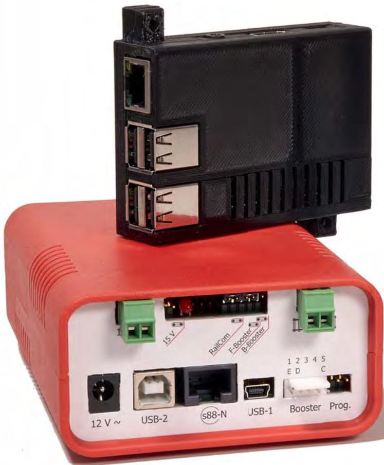
Solche Geräte vermitteln zwischen Anwender und Modellbahn. Sie verrichten dort ihr elektronisches Werk normalerweise im Verborgenen. Im Bild eine Zentrale „Redbox“ von Tams Elektronik mit Anschlussadapter.
