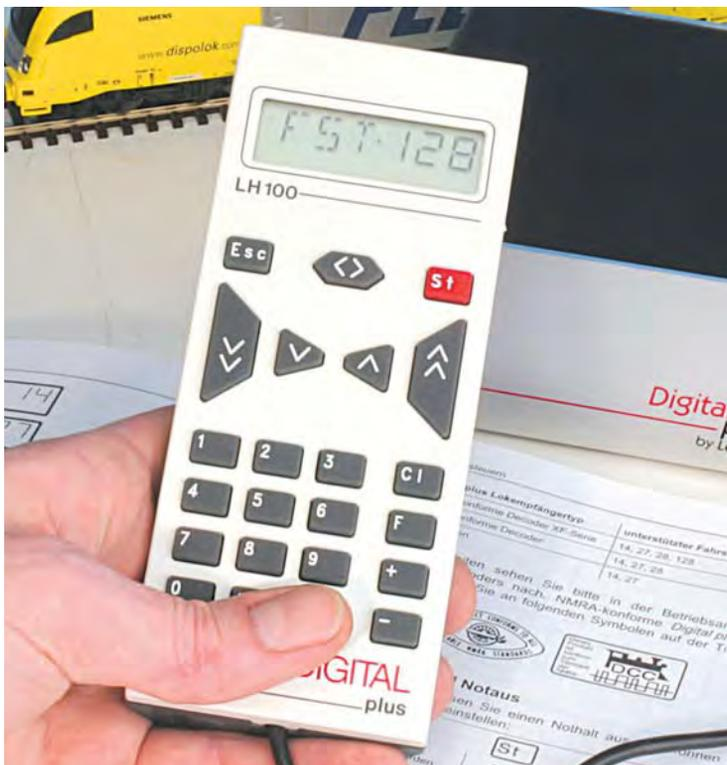
Der Lenz-Handregler LH100 war eines der am längsten ausgelieferten Steuergeräte bei der digitalen Modellbahn. Er ist auch heute noch häufig anzutreffen und beim Händler oder gebraucht erhältlich. Er kommt all den Modellbahnern entgegen, die eine reine Tastenbedienung bevorzugen. Funktionen werden mit den Zifferntasten aufgerufen.
