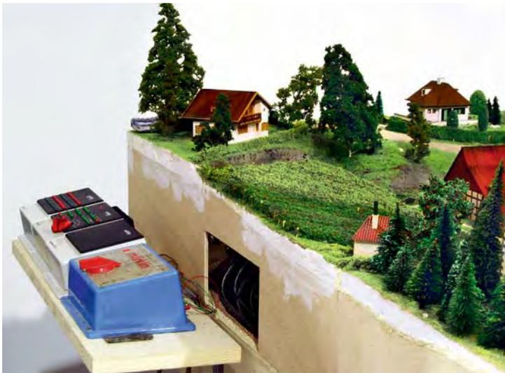
Bedienzentrum aus der Anfangszeit der digitalen Modellbahn: Der alte analoge Fahrtrafo dient noch der Stromversorgung. Die Steuerung von Loks und Wagen erfolgt nun per Zentrale und Tastenfeld.
