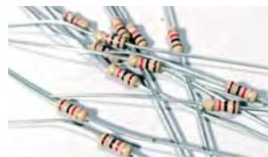
Schaltet man Widerstände parallel, sinkt der Gesamtwiderstand. Das erschließt sich sofort, wenn man an die Leitwerte denkt: Jedes „Röhrchen“ zusätzlich lässt den Gesamtstrom ansteigen, was im Umkehrschluss eine Reduzierung des Widerstands bedeutet. Auch die Rechnung erfolgt über die Leitwerte:
