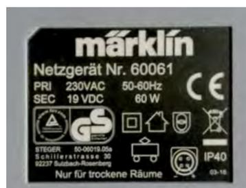
Das Typenschild verrät es: Dieses Schaltnetzteil für eine Märklin CS2-Zentrale gibt 19 V ab und leistet bis zu 60 W. Der Maximalstrom beträgt also 3,15 A.
