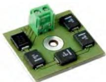
Der Baustein BM1 ist sehr schlicht aufgebaut. Letztlich besteht er nur aus fünf Leistungsdioden.
