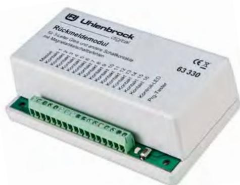
Für viele Modellbahner war die für eine Massemeldung in Verbindung mit der s88-Meldungsübertragung geforderte einfache Technik ein guter Einstieg in eigene Elektronikprojekte. Da ist es nur naheliegend, dass es wohl auch keinen Anbieter von Modellbahnelektronik für das Märklin-Umfeld gibt, der nicht auch selbst einen Massemelder in seinem Programm hätte. Stellvertretend für all die vielen verschiedenen Typen soll hier der Melder von Uhlenbrock stehen, der 16 Zustände per LocoNet weitermeldet.
