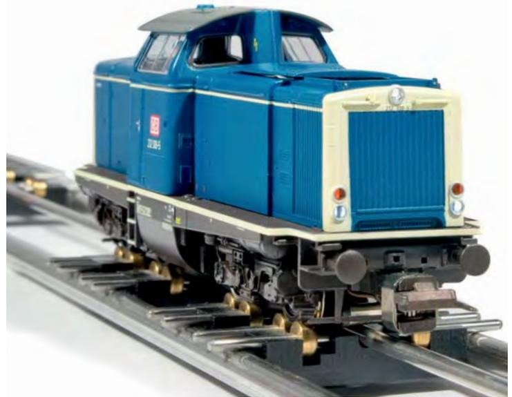
Dieses Modell einer BR 212 mit fernbedienbarer Kupplung steht auf einem Rollenprüfstand.
