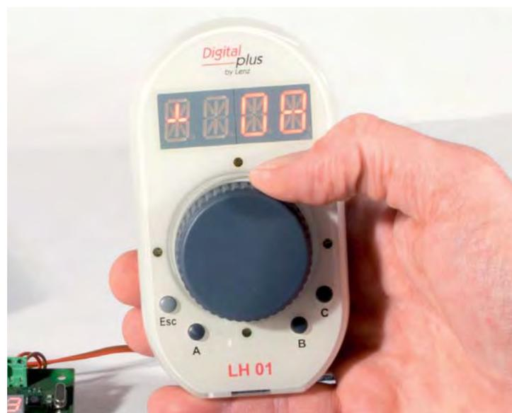
Einem ähnlichen Bedienkonzept wie die Lokmaus folgt der LH 01 von Lenz Elektronik. Er ist ein Beispiel für einen Handregler mit sehr wenigen Funktionstasten. Hier steht das Fahren im Mittelpunkt.
