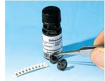
Widerstandsachsen kann man fertig kaufen. Man kann sie sich aber auch selbst machen, indem man einen SMD-Widerstand der Bauform 0603 oder kleiner so am Radsatz angeklebt, dass die Radisolierung überbrückt wird. Den endgültigen Kontakt der beiden Widerstandsenden mit der Radscheibe bzw. der Achse stellt man mit Silberleitlack her. Als Widerstandswert hat sich 10 kΩ bewährt.
