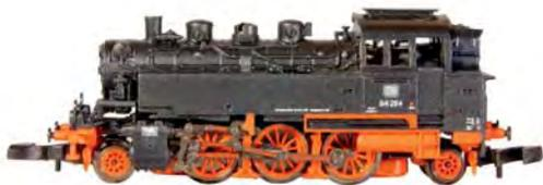
So „groß“ ist eine Lok im Maßstab 1:220 (Z). Die Vorbild-LüP 12,4 m werden zu rund 56,3 mm. Auch diese Lok hat eine winzige Digitalelektronik an Bord.
