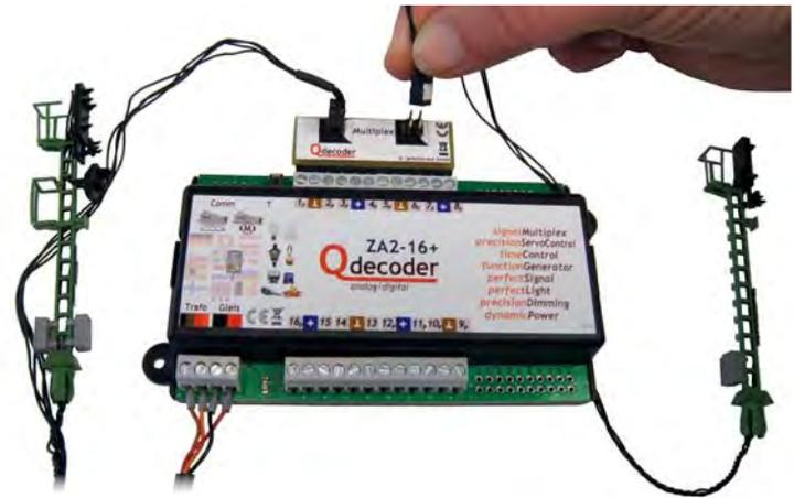
Die Firma QElektronik ist besonders für ihre Signaldecoder bekannt geworden. Man ist in der Lage, fast jedes europäische Signalbild mit passenden Signalmodellen fast jeden Herstellers anzusteuern.
