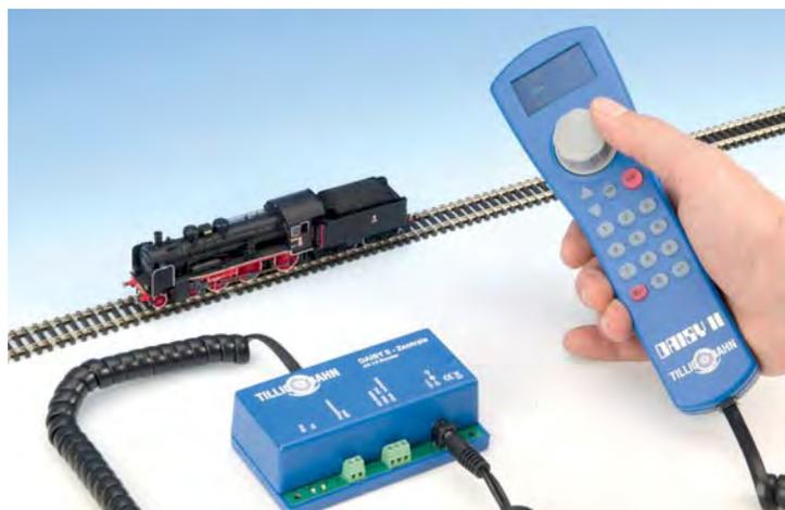
Einige Fahrzeughersteller übernehmen digitale Steuergeräte von etablierten Modellbahndigitalfirmen und lassen diese auf die eigenen Bedürfnisse anpassen. Die hier gezeigte Daisy II wird von Uhlenbrock hergestellt, Tilling hat sie im mit der Hausfarbe versehenen Gehäuse für die eigenen TT-Startpackungen übernommen.
