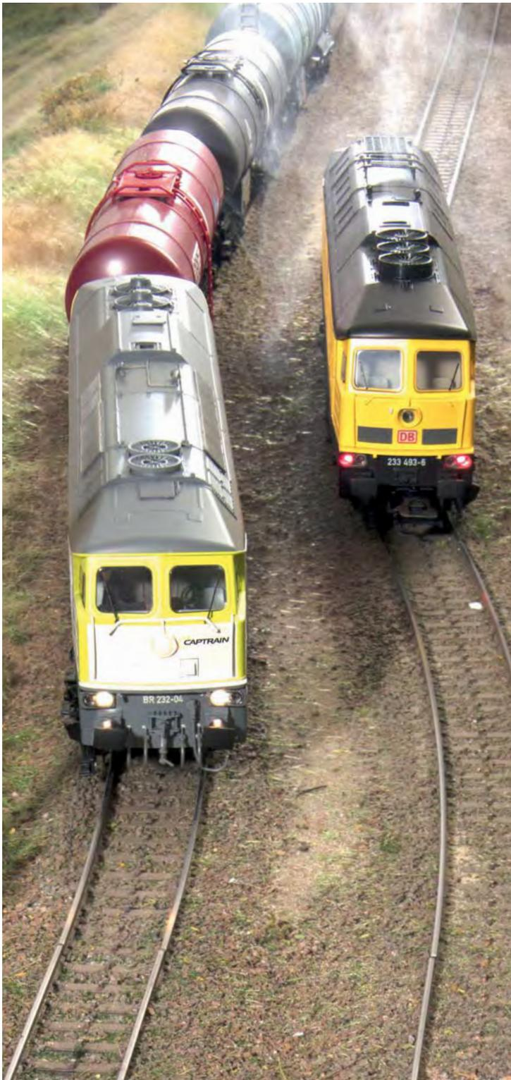
Zweimal Ludmilla, beide digital und mit speziellen Fähigkeiten: von Esu die Lok Captrain BR 232-04 mit Raucherzeuger für klassisches Verdampferöl, von Märklin die Lok 233 493 „Tiger“ der DB AG Bahnbau Gruppe. Im Tiger ist ein Ultraschallzerstäuber installiert, der ähnlich wie Büro-Nebelbrunnen mit destilliertem Wasser funktioniert.
