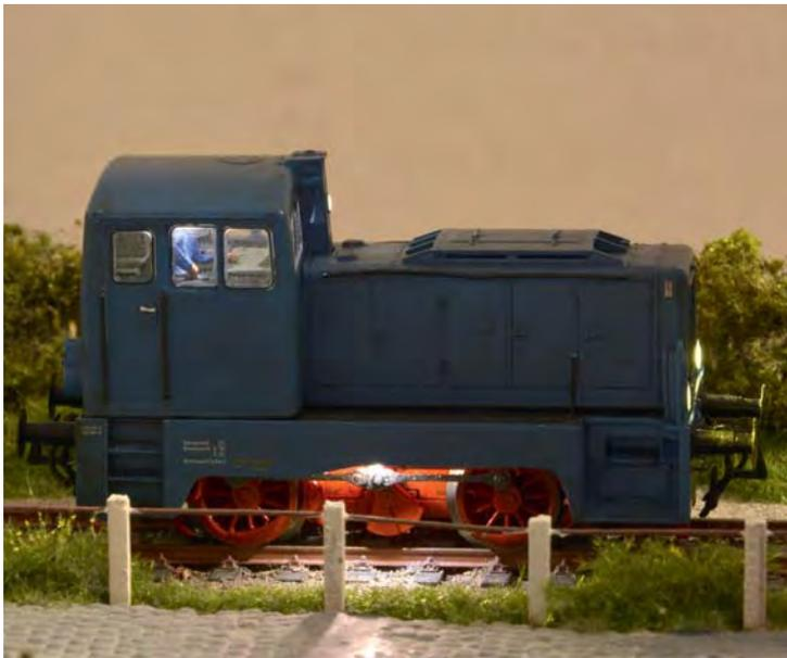
Dieses H0-Modell einer V 15 von Piko hat neben einer Führerstandsbeleuchtung auch eine Triebwerkslampe erhalten – beides digital getrennt schaltbar.
