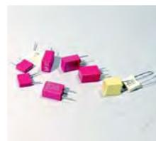
Das Schaltzeichen eines Kondensators symbolisiert seinen prinzipiellen Aufbau: Zwei leitende Platten werden nah aneinander gebracht, ohne sich zu berühren. Diese Anordnung kann elektrische Ladung aufnehmen und speichern. Wie viel, hängt von der Größe der Platten und dem Material zwischen ihnen ab. Dieses Material wird Dielektrikum genannt.
