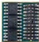
Funktionsdecoder hören auf Fahrzeugadressen wie normale Fahrdecoder. Sie können jedoch keine Motoren ansteuern, sondern stellen nur Schaltausgänge für Funktionen zur Verfügung. Funktionsdecoder werden gerne in Steuerwagen eingesetzt, um z.B. das Fahrlicht und die Innenbeleuchtung passend zu schalten, ohne eine direkte Kabelverbindung zum Fahrdecoder haben zu müssen. Das Bild zeigt einen FH22A von Doehler & Haass für eine PluX22-Schnittstelle.
