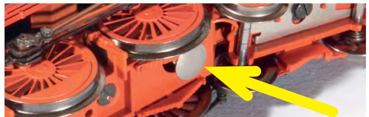
Fleischmann-H0-Loks besitzen einen pilzförmigen Kontakt auf der Unterseite. Dieser verband eine kurze Schleifleiste im Gleis mit der danebenliegenden Schiene. Diese Meldetechnik sollte man im Digitalbetrieb nicht mehr einsetzen.
