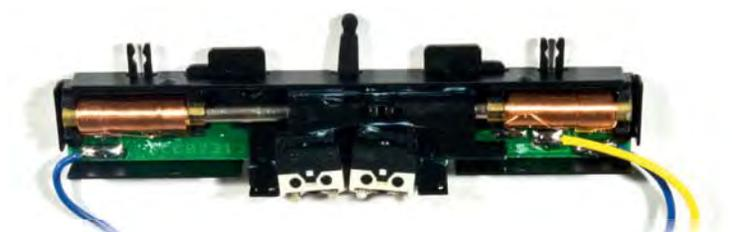
Der Doppelspulenantrieb für Märklin-K-Gleis-Weichen weist zwei Schalter auf. Diese werden in der jeweiligen Endlage des Antriebszylinders betätigt und trennen die zugehörige Spule vom weiteren Stromfluss ab. So wird ein Dauerstrom verhindert und damit, dass die Spule durchbrennt.
