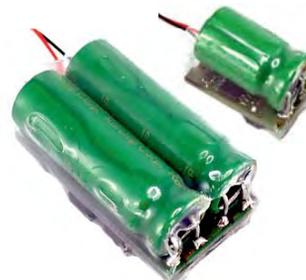
PowerPack mini und PowerPack mini von Esu basieren auf der GoldCap-Technologie und können nur an LokPilot- und LokSound-Decodern eingesetzt werden. Der kleine PowerPack hat eine Kapazität von 1 x 1 F bei 15,7 x 9,7 x 13 mm, der große 2 x 5 F bei 27,5 x 15,7 x 13 mm.
