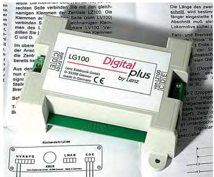
Der LG100 ist ein DCC-Bremsgenerator, ein Gerät, das an seinem Ausgang ein digitales Gleissignal bereitstellt, das allen Triebfahrzeugen das geordnete Anhalten unter Beachtung der Massesimulation befiehlt.
