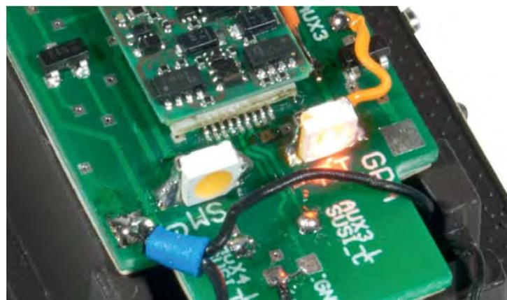
Die zwei weißen aufrecht stehenden Bauteile sind LEDs im PLCC-Gehäuse. Sie leuchten direkt in Kunststofflichtleiter.
