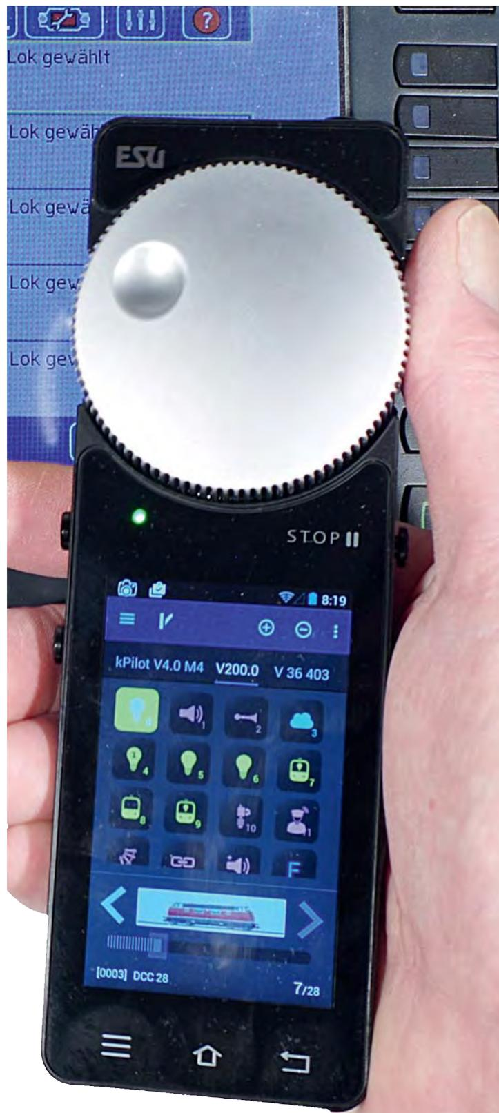
Bediengeräte mit Touchdisplay eignen sich sehr gut, um die Möglichkeiten eines Modells mit Symbolen darzustellen. Hier wird eine V-200-Nachbildung mit einem Mobile Control II von Esu gesteuert.
