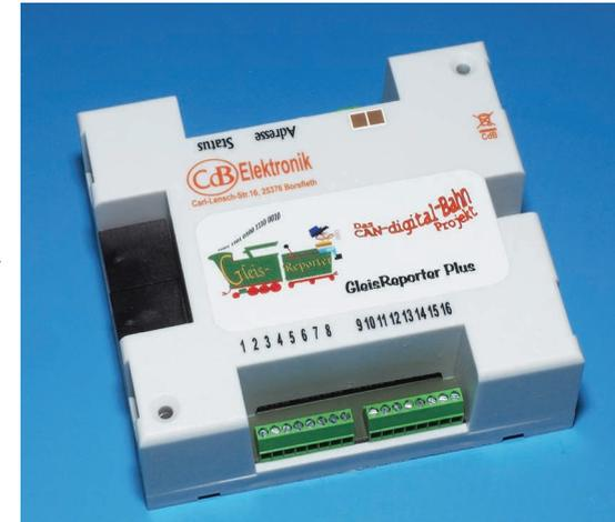
Das Modul entspricht in seiner Funktionsweise einem einfachen Rückmeldemodul der s88-Bauart zum Anschluss von Schalt- oder Kontaktgleisen. Die Module verfügen zur Fahrzeugerkennung über eine eigene Messspannung, die vom Rest der Modellbahn völlig unabhängig ist. Es ist für den Betrieb keine zusätzlich Spannungsversorgung erforderlich.
