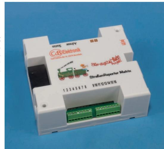
Das Modul entspricht in seiner Grundfunktion einem einfachen Rückmeldemodul der s88-Bauart zum Anschluss von Tasten oder Reedkontakten. Es ist aber dazu in der Lage, selbst kürzeste Impulse digital zu korrekten Meldungen für einen störungsfreien Betrieb aufzubereiten. Die Nachlaufzeit eines Impulses ist dabei frei über ein Service-Tool einstellbar. Im Matrix-Betrieb können bis zu 64 Tasten erfasst werden, die entweder Rückmeldungen oder Schaltbefehle auslösen können.
