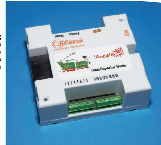
Das Modul entspricht in seiner Funktionsweise einem einfachen Rückmeldemodul der s88-Bauart zum Anschluss von Schalt- oder Kontaktgleisen, wie auch für Lichtschranken.
