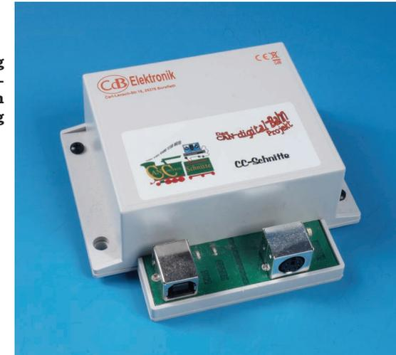
Die CC-Schnitte ist ein reines Interface, das die Daten nicht verändert! Das Modul verbindet lediglich den CAN-Bus über einen virtuellen COM-Port mit dem PC und ermöglicht einen Datenaustausch in beide Richtungen.
