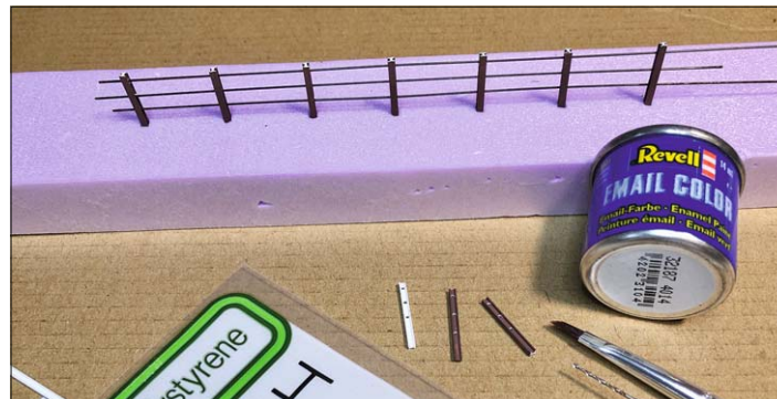
Der Zaun zwischen Bahnstrecke und Betriebswerk entstand aus Polystyrol-H-Profilen (1,5 x 1,5 mm) und Draht. Die 0,5-mm-Löcher wurden mit einem Stiftenklöbchen gebohrt.
