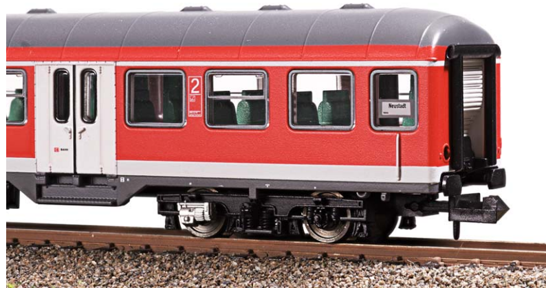
Bei der Ausführung des DB-Regio-Wagens endet die verkehrsrote Lackierung im Dachbereich auf Höhe des Gummiwulstes.
