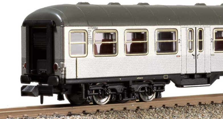
Alle Details wie Steuerleitung, Rangierergriffe und Türöffner sind am Wagenkasten angeformt. Die Übersetzfenster sind feingestaltet.
