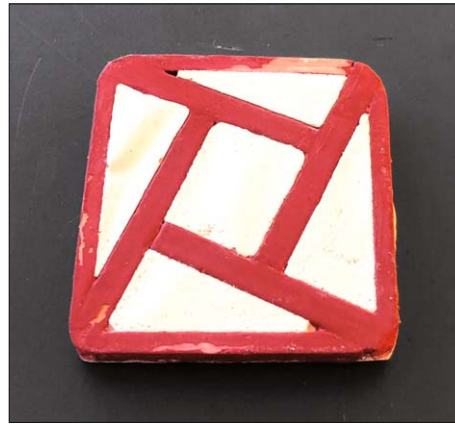
An einem kleinen Testfachwerk wurde das Ausgießen des Gefaches ausprobiert.
